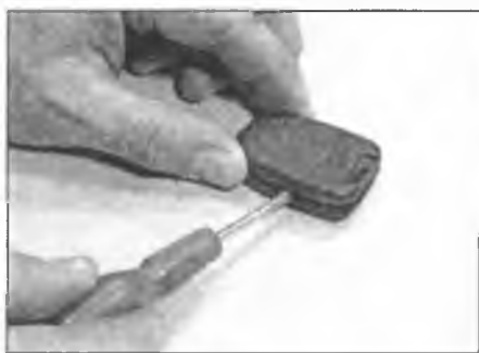
Рис. 28.2.а. Аккуратно вставьте отвертку в щель ...
