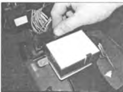
Рис. 23.13. Отожмите зажимы и снимите БЭУ с поддона
