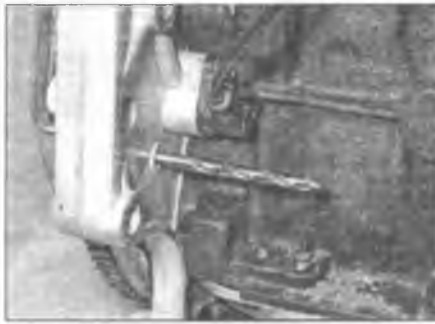
Рис. 3.8. Застопорьте коленчатый вал; для этого вставьте стержень диаметром 6.75 мм в отверстие в маховике, пропустив его через отверстие на тыльной стороне опорной пластины
