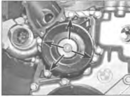
Рис. 5.30,а. Выверните четыре болта (отмечены стрелками) и снимите насос охлаждающей жидкости
