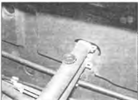
Рис. 31.16. Выверните винт выпуска воздуха из возвратного шланга отопителя около перегородки моторного отделения
