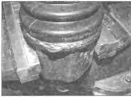
Рис. 4.1В. Зафиксируйте чехол внутреннего шарнира прилагаемыми хомутами
