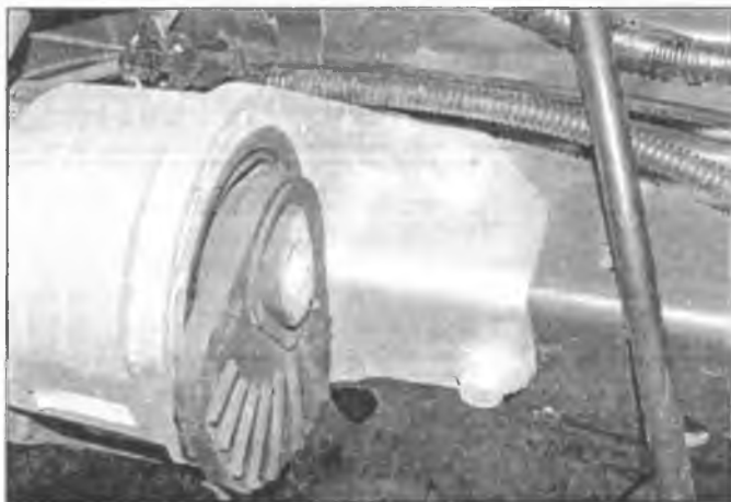
Рис. 14.10. Выверните болты крепления левой опоры к кузову
