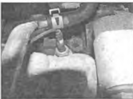
Рис. 7.11. Рассоедините электрический разъем датчика указателя температуры – дизельный двигатель серии "L"
