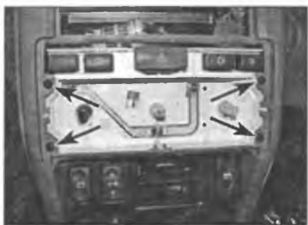
Рис. 28.9. Выверните четыре винта около места расположения панели управления отопителем (отмечены стрелками)
