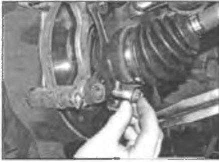
Рис. 8.22. Установите опорный кронштейн суппорта и затяните болты предписанным усилием
