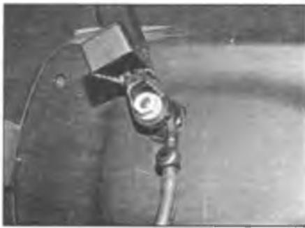
Рис. 15.3,в. Отсоедините от стеклоочистителя двери багажного отделения шланг омывателя
