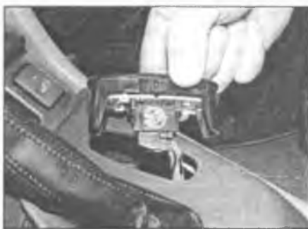
Рис. 4.2. Рассоедините электрический разъем указателя
