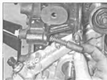
Рис. 9.21. Аккуратно выверните болт и извлеките плунжер и пружину из корпуса натяжителя
