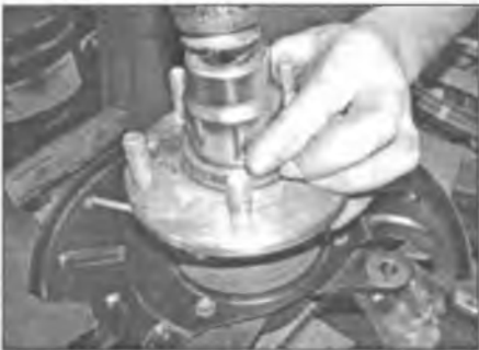
Рис. 4.19. Вставьте конец вала ступицы в подшипник поворотного кулака и легкими ударами запрессуйте ступицу на место
