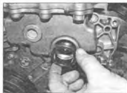
Рис. 10.48,а. Вверните специальный инструмент LRT 12-178/1 в крышку цепи газораспределительного механизма, ...
