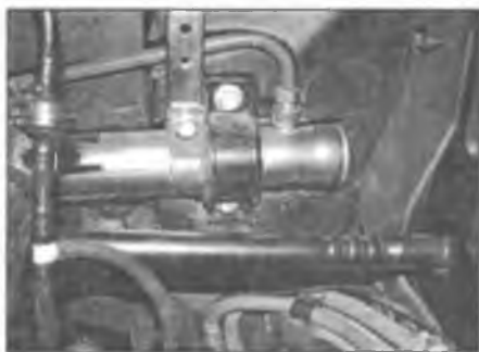
Рис. 18.7. На левом конце рулевого механизма выверните два болта (с шайбами) крепления зажимной планки рулевого механизма
