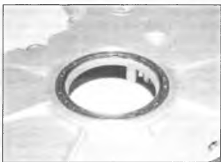
Рис. 7.12, б. ... и вставьте манжету таким образом, чтобы она была заподлицо с крышкой
