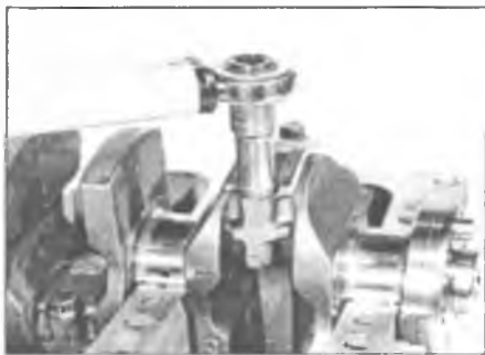
Рис. 20.24, а. Затяните болты крышки нижней головки шатуна усилием согласно стадии 1, ...
