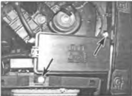
Рис. 4.6,а. Выверните болты крепления коробки плавких предохранителей (отмечены стрелками)
