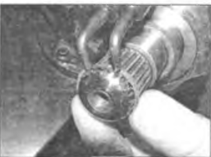
Рис. 2.14. Установите новое стопорное кольцо в канавку на полуоси
