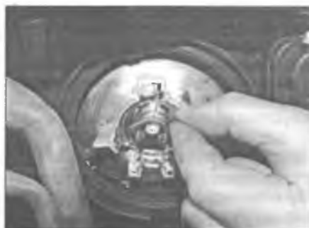
Рис. 5.4. Отцепите и высвободите верхний зажим крепления лампы, отжав его в сторону, и для доступа к лампе опустите его
