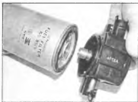
Рис. 34.5. Наверните головку фильтра на фильтр, обеспечив контакт уплотнения с головкой
