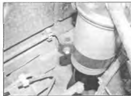
Рис. 25.3. Отпустите зажимной болт фильтра и снимите фильтр с кронштейна
