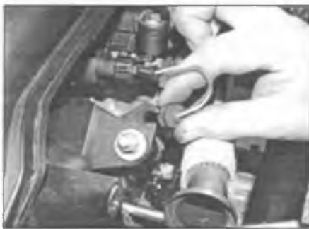
Рис. 19.29. Высвободите уплотнительную втулку жгута электропроводки датчика давления топлива из впускного коллектора
