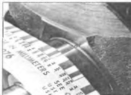
Рис. 20.17. Определите ширину деформированной нити Plastigauge по данной шкале
