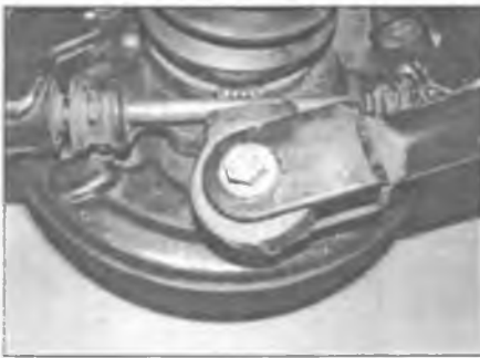
Рис. 3.4. Выверните болт крепления продольного рычага из основания опоры ступицы колеса
