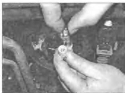
Рис. 5.11. Лампа габаритного фонаря фиксируется в патроне по плотной посадке
