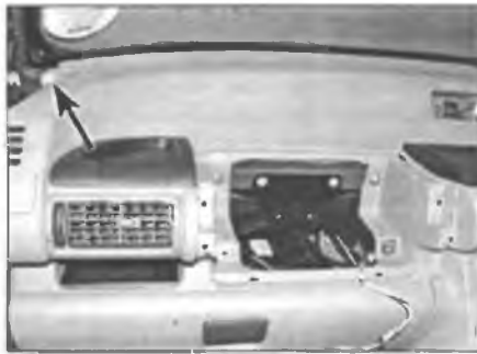
Рис. 29.11, а. По одному винту крепления лицевой панели с каждой стороны точно в двух нижних углах ветрового стекла (отмечены стрелками), ...
