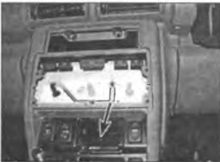
Рис. 28.10,а. Центральная консоль теперь фиксируется одним винтом внутри "кармана" / пепельницы под органами управления отопителем (отмечен стрелкой) ...
