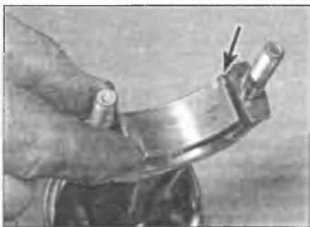
Рис. 21.27.а. Если у вкладыша есть установочный выступ, проследите, чтобы этот выступ вошел в паз (отмечено стрелкой) на крышке/ шатуне
