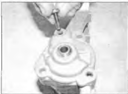
Рис. 10.2. Выверните болты и снимите крышку масляного насоса
