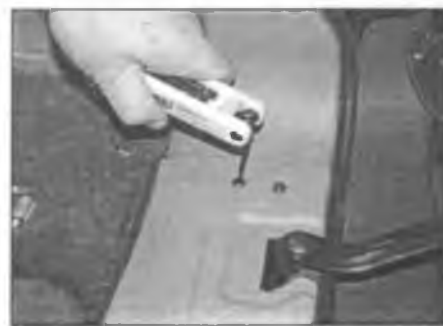
Рис. 27.27. Выверните винты крепления держателя напольного покрытия
