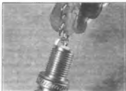
Рис. 32.14,в. ... и при необходимости отрегулируйте зазор, подгибая боковой электрод
