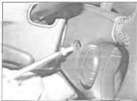
Рис. 23.3. Подушка безопасности крепится к рулевому колесу двумя винтами
