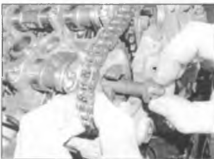
Рис. 6.23. Вверните новые болты крепления звездочек и затяните их только усилием руки
