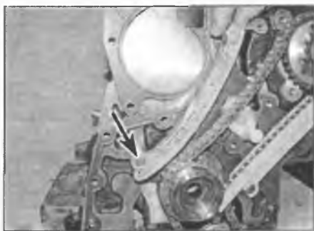
Рис. 8.6,а. Снимите заднюю направляющую цепи с ее пальца (отмечен стрелкой)
