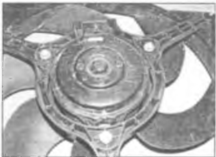
Рис. 6.28. Выверните три болта крепления электродвигателя вентилятора
