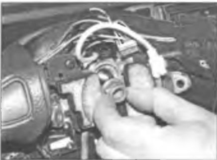
Рис. 14.4. Отверните гайку крепления рулевого колеса
