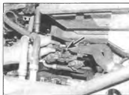
Рис. 35.4. Извлеките пробку заливной горловины (отмечена стрелкой) наверху коробки передач
