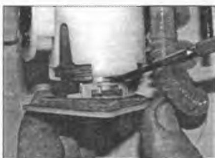
Рис. 8.3. Отпустите зажим крепления фильтра к основанию насоса
