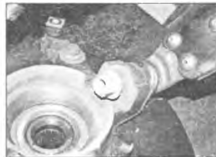
Рис. 3.8. Полностью отпустите, но не отворачивайте совсем гайку крепления нижнего шарового шарнира к поворотному кулаку
