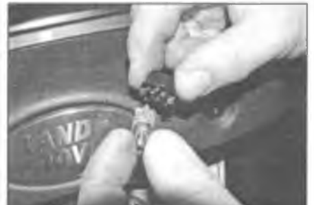
Рис. 5.33,б ... и вытяните лампу из патрона
