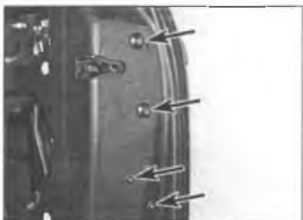
Рис. 16.5. Выверните четыре винта крепления замка (отмечены стрелками)
