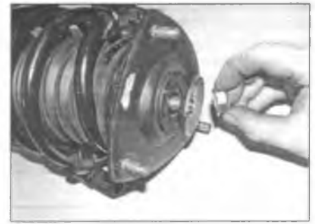
Рис. 2.10. Отверните гайку и выбросьте ее; при установке следует использовать новую
