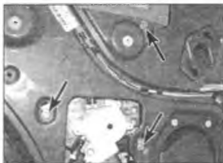
Рис. 14.20. Выверните три болта (отмечены стрелками) крепления стеклоподъемника к панели двери
