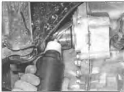
Рис. 6.4. Долейте предписанное трансмиссионное масло в коробку передач
