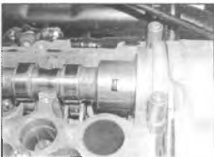
Рис. 6.19,б. Соедините левый конец выпускного распределительного вала с муфтой вакуумного насоса
