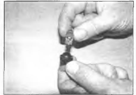
Рис. 6.31. Лампы подсветки щитка приборов фиксируются в своих патронах по плотной посадке
