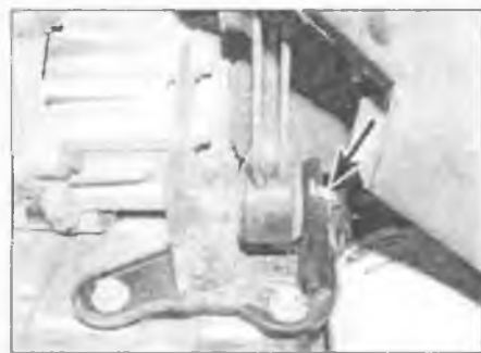
Рис. 7.9,а. Выверните болт крепления нижней стяжки к поддону (отмечен стрелкой)...
