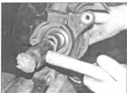
Рис. 4.11. Используйте подходящую оправку для выпрессовки ступицы
