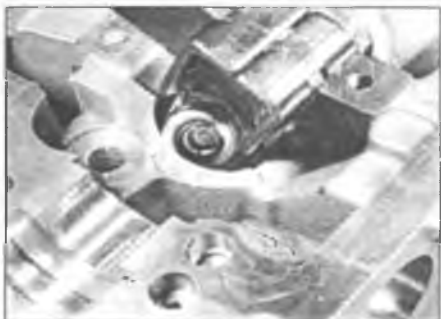
Рис. 9.3,а. Чтобы сжать пружину клапана, используйте приспособление для сжатия пружин клапанов
