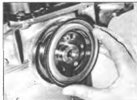
Рис. 15.9. Смажьте уплотнительные кромки новой манжеты и буртик коленчатого вала и установите манжету в блок цилиндров/картер двигателя
