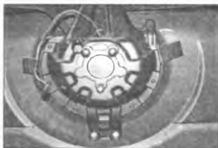
Рис. 24.16 Выверните шесть болтов, отверните две гайки, освободите жгут электропроводки из зажимов и снимите кронштейн запасного колеса с двери багажного отделения
