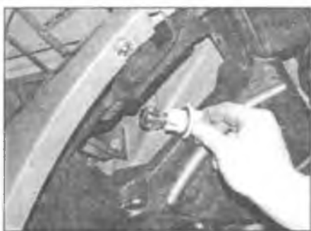
Рис. 5.15. Через проем дотянитесь до патрона лампы и для снятия поверните его против часовой стрелки
