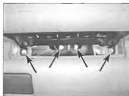
Рис. 23.9. Подушка безопасности пассажира крепится к лицевой панели четырьмя болтами (отмечены стрелкой)
