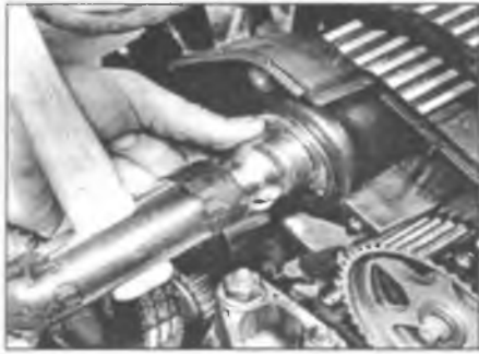
Рис. 9.4. Для установки уплотнительной манжеты распределительного вала в требуемое положение используйте торцевую головку
