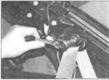
Рис. 26.18,а. Выверните болт верхнего элемента крепления ремня безопасности,
