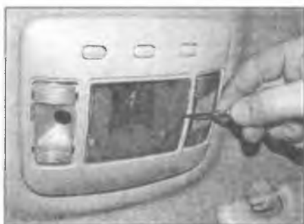
Рис. 6.2. Вставив подходящую отвертку в специальную выемку на краю рассеивателя, аккуратно подденьте рассеиватель и снимите его
