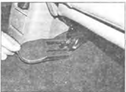
Рис. 25.4. Задний внутренний болт крепления сиденья скрыт под пластиковой крышкой
