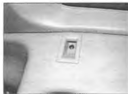
Рис. 27.25. Выверните винт, расположенный в установочном гнезде откидной декоративной крышки багажного отделения
