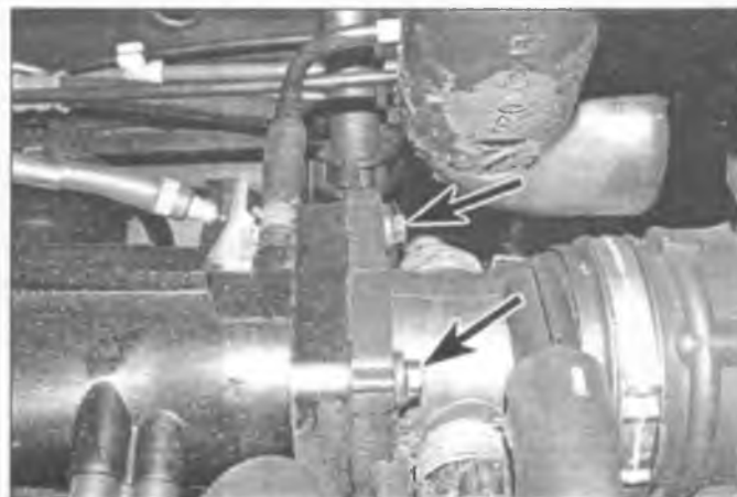
Рис. 11.7. Выверните четыре винта крепления корпуса дроссельной заслонки (верхние винты отмечены стрелками)
