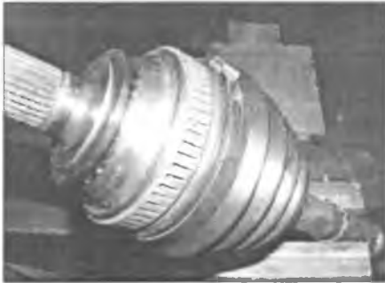
Рис. 20.31. Импульсное колесо датчика – это неотъемлемая часть ШРУСа, и оно не может быть заменено отдельно
