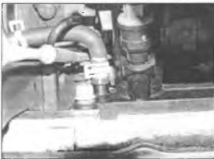
Рис. 4.28. Отсоедините вентиляционный шланг расширительного бачка от двигателя
