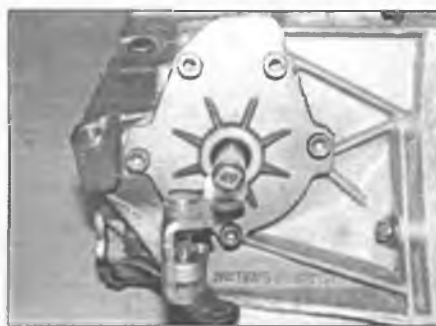
Рис. 4.31. Выверните пять винтов, снимите крышку привода переключения передач
