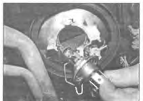
Рис. 5.5. Извлеките лампу из фары
