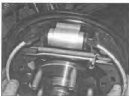
Рис. 5.23. Расположите тормозные колодки по обеим сторонам колесного цилиндра
