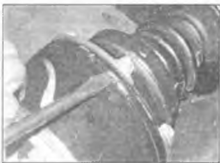
Рис. 7.21. Обожмите "жестянку" чехла в трех равномерно расположенных по окружности точках, чтобы зафиксировать чехол на корпусе шарнира
