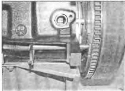
Рис. 3.7,б. Пропустите блокирующий стержень через отверстие в блоке цилиндров и вставьте его в отверстие на маховике
