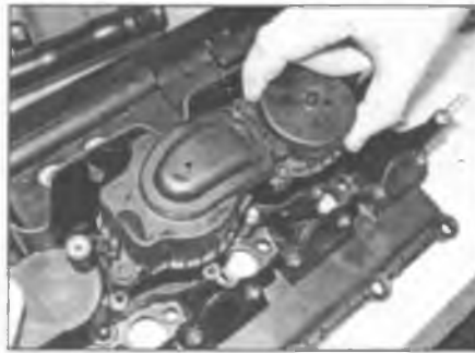
Рис. 3.6. Снимите клапан ограничения разрежения вместе с фильтром
