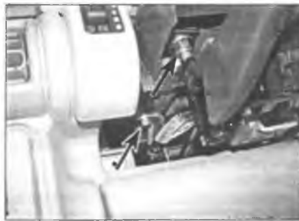
Рис. 17.11, б. ... крепления рулевой колонки к направляющей опоре лицевой панели
