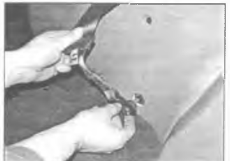
Рис. 26.17. Выверните болт нижнего крепления ремня безопасности заднего сиденья
