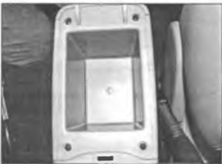
Рис. 28.20. Выверните четыре винта, поднимите и снимите вещевой ящик
