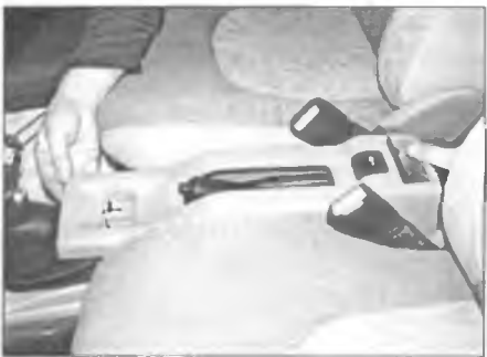
Рис. 28.17,б. ... и приподнимите консоль над рычагом стояночного тормоза
