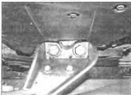
Рис. 4.36. Выверните болты опорного кронштейна двигателя
