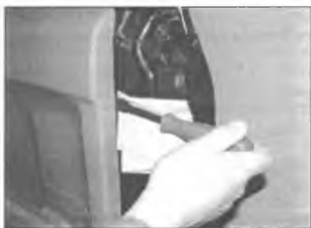
Рис. 16.3,а. Высвободите фиксаторы с помощью широкой отвертки ...
