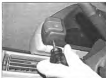
Рис. 4.13. Выверните винты ниже кнопок переключателя
