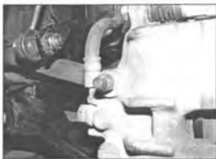
Рис. 2.14. Снимите пылезащитный колпачок с винта выпуска воздуха
