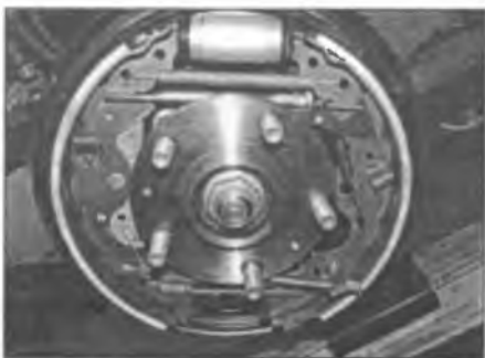
Рис. 5.27. Обратите внимание на расположение зажимов фиксации колодок
