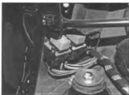
Рис. 3.11,б. Реле электродвигателя стеклоподъемника и реле электродвигателя стеклоочистителя двери багажного отделения
