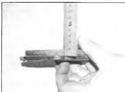
Рис. 12.4. Проверьте толщину фрикционного материала тормозной колодки
