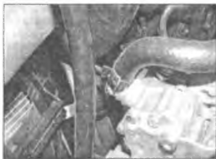
Рис. 20.31 Отпустите подпружиненный хомут крепления питающего шланга к насосу
