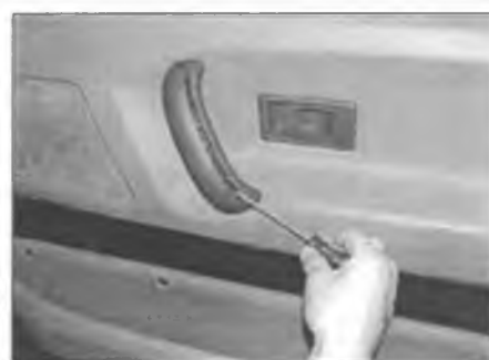
Рис. 12.3,а. Снимите центральную секцию с внутреннего поручня двери, ...
