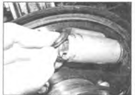
Рис. 5.15. Снимите пылезащитные резиновые чехлы, проверьте колесный цилиндр на наличие утечки тормозной жидкости
