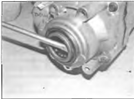
Рис. 3.3. Аккуратно подденьте манжету большой плоской отверткой и извлеките ее из раздаточной коробки
