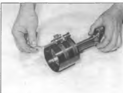
Рис. 21.29. Проверьте правильность распределения замков колец по окружности и сожмите кольца с помощью соответствующего приспособления
