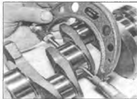
Рис. 16.10. Измерьте диаметр коренной шейки коленчатого вала
