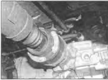
Рис. 4.5. Отметьте положение карданного вала относительно выходного фланца раздаточной коробки
