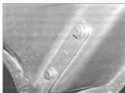
Рис. 8.3. Выверните болты крепления капота
