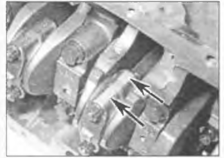
Рис. 12.12. Перед снятием нанесите идентификационные отметки (отмечены стрелками) на каждый шатун и ответную крышку подшипника
