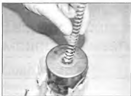
Рис. 33.3,б. Извлеките пружину из фильтра
