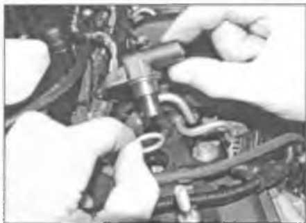
Рис. 12.97. Выверните винт, снимите датчик положения распределительного вала. Уплотнительное кольцо следует заменить
