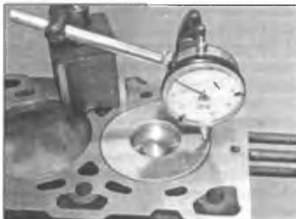
Рис. 7.33. Измерение выступа поршня
