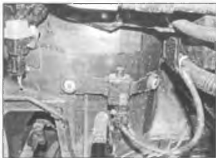
Рис. 4.21. Рассоедините электрический разъем клапана продувки
