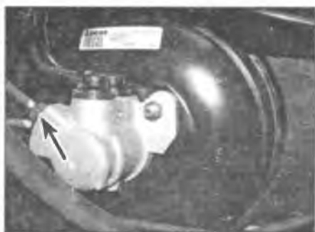
Рис. 9.3. Отверните гайки штуцерных соединений и аккуратно отсоедините трубопроводы
