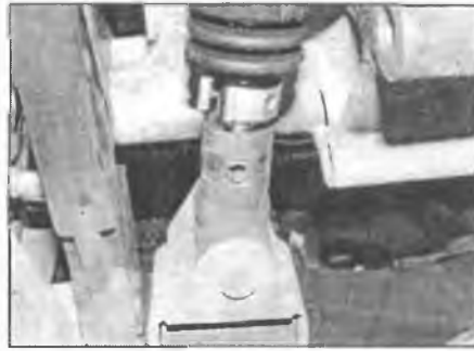
Рис. 4.6. Отожмите назад крышку и кернером выбейте цилиндрический штифт тяги переключения передач
