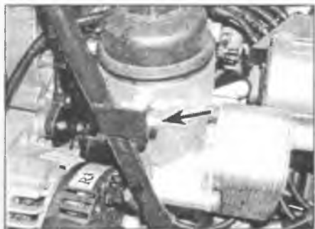
Рис. 8.4. Выверните болт крепления трубки указателя уровня масла к корпусу масляного фильтра
