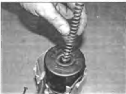
Рис. 8.14. Установите пружину в верхнюю часть фильтра
