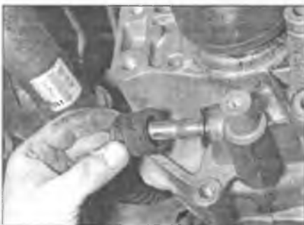
Рис. 4.17. Снимите резиновый чехол
