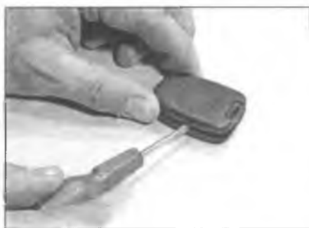
Рис. 30.2.а. Аккуратно вставьте отвертку в щель ...
