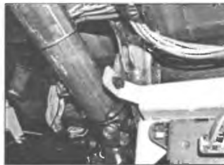
Рис. 17.10. Выверните болт крепления рулевой колонки к опорному кронштейну коробки плавких предохранителей
