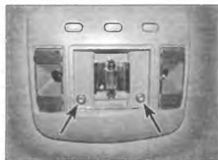
Рис. 6.5. Выверните два винта крепления плафона освещения салона
