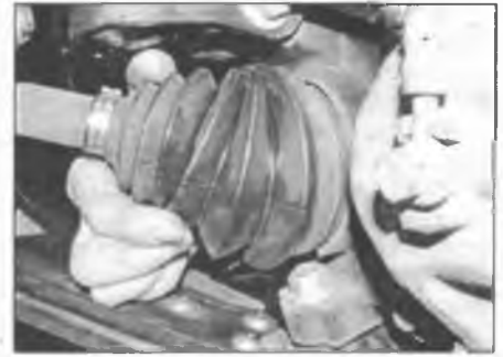
Рис. 17.1. Проверьте состояние резиновых чехлов наружных шарниров равных угловых скоростей
