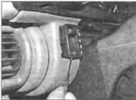
Рис. 4.27. Аккуратно подденьте переключатель коррекции наклона света фар и выньте его из гнезда. Будьте осторожны, чтобы не повредить лицевую панель
