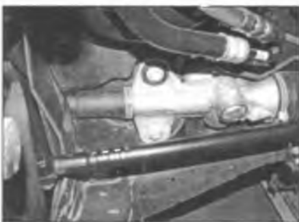
Рис. 18.8. На правом конце рулевого механизма выверните два болта крепления опорного фланца рулевого механизма к перегородке
