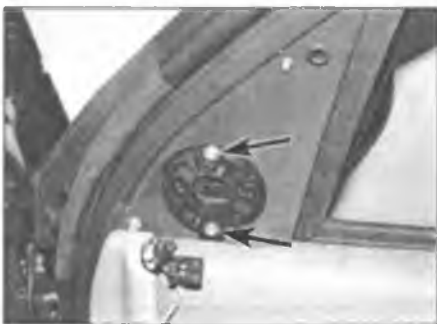
Рис. 23.3. Придержите зеркало и выверните винты (отмечены стрелками)
