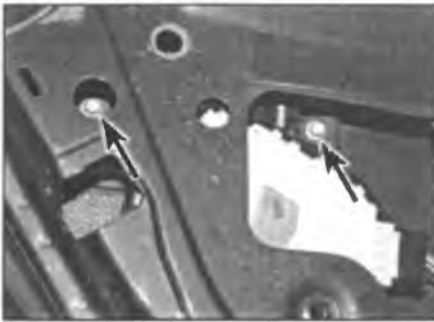
Рис. 13.21. Выверните болты (отмечены стрелками) и снимите наружную ручку
