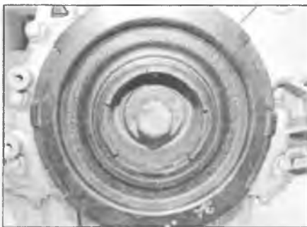
Рис. 5.8. Перед затягиванием болтов нанесите белой краской отметки на головку болта и шкив
