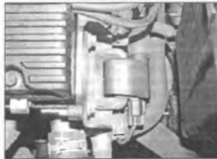
Рис. 4.33. Снимите кронштейн катушки зажигания и подсоедините проушину подъема двигателя
