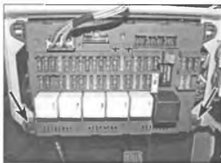
Рис. 24.5. Выверните два болта крепления коробки плавких предохранителей к опорной пластине (отмечены стрелками)
