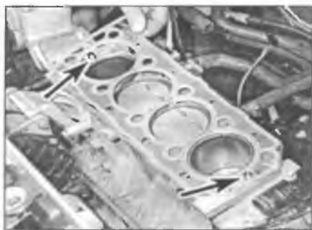
Рис. 11.23. Убедитесь в наличии установочных штифтов (отмечены стрелками) и установите новую прокладку головки цилиндров ...
