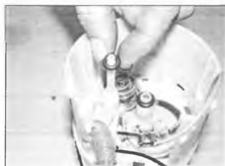
Рис. 33.5. Перед установкой новых уплотнительных колец смажьте их силиконовой смазкой
