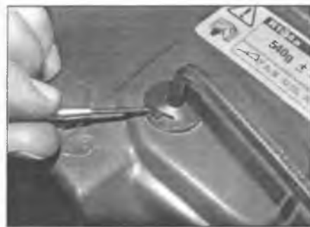
Рис. 3.27. Выверните пальцы крепления радиатора из панели замка капота
