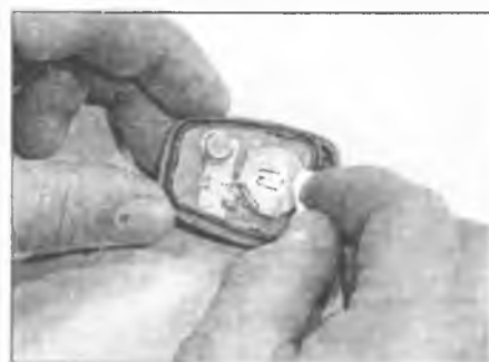
Рис. 28.3. Положительная сторона (+) нового элемента питания должна быть обращена вверх
