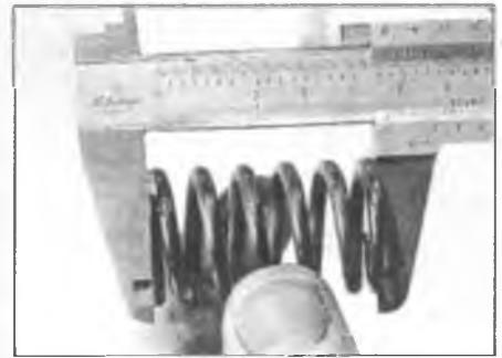
Рис. 10.19. Измерьте длину пружины клапана в свободном состоянии
