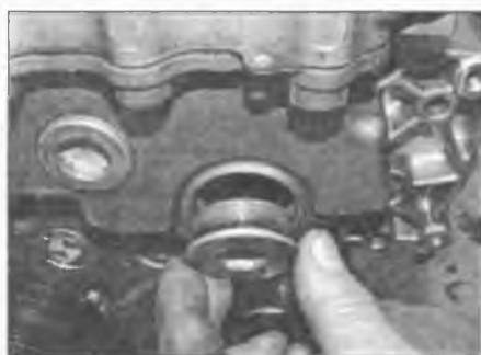
Рис. 10.46. Выверните заглушку доступа из крышки цепи газораспределительного механизма
