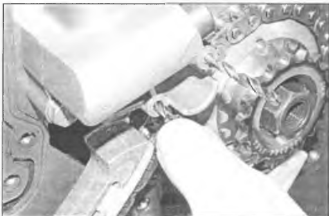
Рис. 8.4. Вставьте нижний плунжер в корпус натяжителя, если нет фирменного специального инструмента, чтобы застопорить плунжер, вставьте сверло диаметром 4 мм
