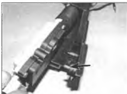
Рис. 16.8. Электродвигатель централизованного запираения замка можно отсоединить от замка после вывинчивания одного винта (отмечен стрелкой)
