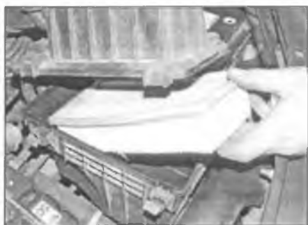
Рис. 27.4. Извлеките фильтрующий элемент, отметив положение его установки
