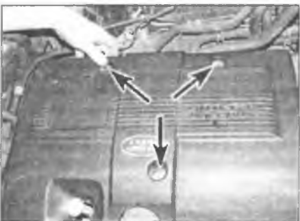
Рис. 4.1. Выверните болты (отмечены стрелками) и снимите пластиковую крышку двигателя
