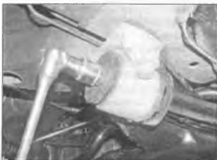
Рис. 5.77. Отпустите гайки (по одной с каждой стороны) крепления опорных втулок к нижнему рычагу
