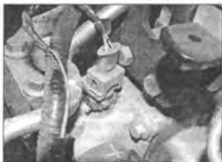
Рис. 7.5. Рассоедините электрический разъем и выверните датчик – дизельный двигатель серии "L"
