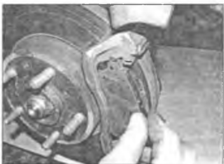
Рис. 4.3. Извлеките тормозные колодки из опорного кронштейна суппорта
