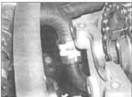
Рис. 19.37. Отсоедините шланг расширительного бачка от трубы охлаждающей жидкости
