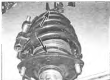
Рис. 2.19. Установите верхнюю опорную пластину, чтобы стрелка на ее верхней поверхности (отмечена стрелкой) была направлена к внешней стороне автомобиля, параллельно кронштейнам крепления стойки к поворотному кулаку (отмечены стрелкой), расположенным на нижнем конце стойки
