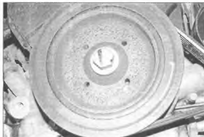
Рис. 5.5. Выверните болт и снимите шкив с коленчатого вала
