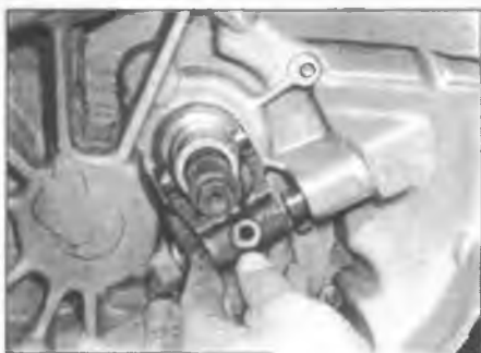
Рис. 7.3. Выверните болт крепления вилки выключения к оси рычага и снимите его вместе с шайбой
