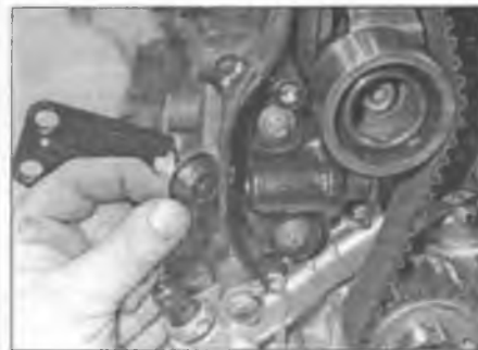
Рис. 7.23. Извлеките резиновую пробку, чтобы получить доступ к задней части плунжера натяжителя
