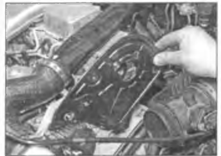
Рис. 11.8,б. ... и снимите заднюю крышку ремня топливного насоса высокого давления с головки цилиндров
