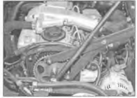
Рис. 9.3. Для удерживания звездочки распределительного вала при отпускании болта используйте инструмент, сделанный своими руками
