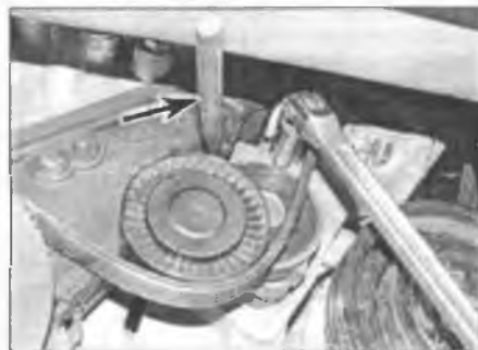
Рис. 10.30. Отведите натяжитель от ремня и вставьте стержень диаметром 2 – 3 мм (отмечен стрелкой) в отверстие в рычаге натяжителя и в шток шкива
