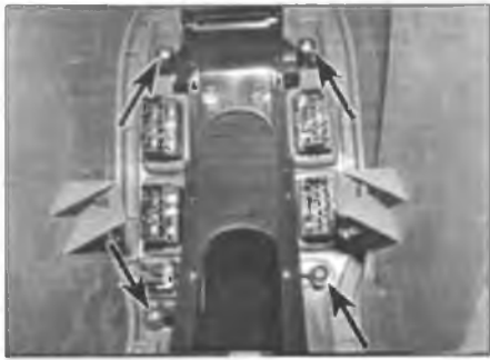
Рис. 28.24. Выверните четыре винта и снимите экран рычага стояночного тормоза
