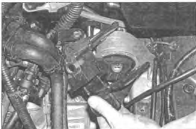
Рис. 8.66. Выверните четыре болта и снимите левый опорный кронштейн с коробки передач
