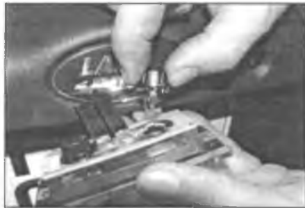
Рис. 5.33,а. Чтобы извлечь патрон соответствующей лампы (лампы две) освещения номерного знака из корпуса, поверните его против часовой стрелки ...
