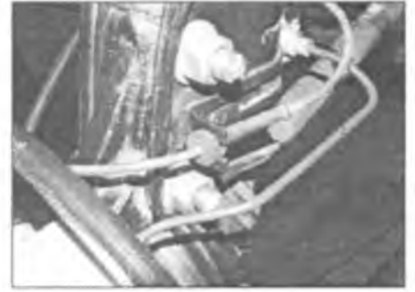
Рис. 9.5. Отверните две гайки и извлеките болты крепления нижнего конца стойки к опоре ступицы
