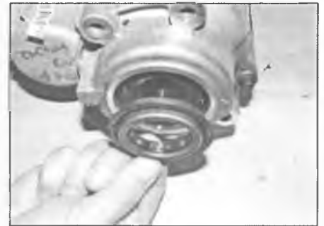
Рис. 3.5. Устанавливайте манжету в выточку, чтобы уплотнительная кромка была обращена в сторону раздаточной коробки
