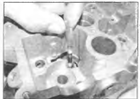
Рис. 11.2,а. Установите на стержень клапана защиту маслоотражательного колпачка (при наличии),...
