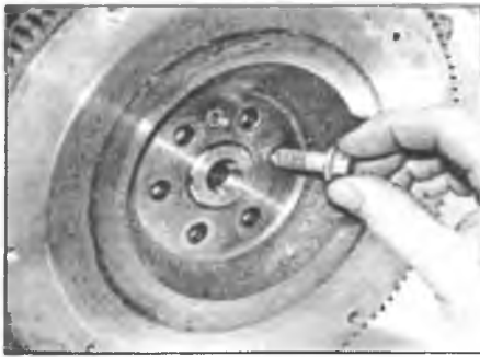
Рис. 16.8. Установите маховик, ориентируясь на установочный штифт, и вверните новые болты
