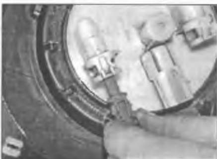
Рис. 8.6. Нажмите на стопорные лапки и отсоедините топливный шланг
