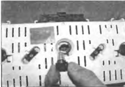
Рис. 6.30. Поверните патрон соответствующей лампы против часовой стрелки и извлеките его из тыльной части панели
