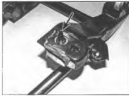
Рис. 13.7. Положение заднего подрамника определяется установочными штифтами (один из них отмечен стрелкой)
