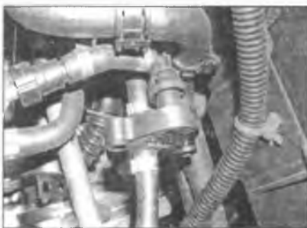
Рис. 12.62. Переключатель температуры топлива – двигатель TD4
