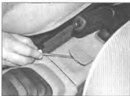
Рис. 28.14,а. Подденьте и снимите крышку перед стояночным тормозом
