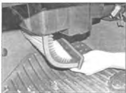
Рис. 24.2. Извлеките пылевой фильтр из отсека
