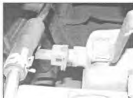
Рис. 12.25. Датчик температуры воздуха забора ввернут в правый конец впускного коллектора
