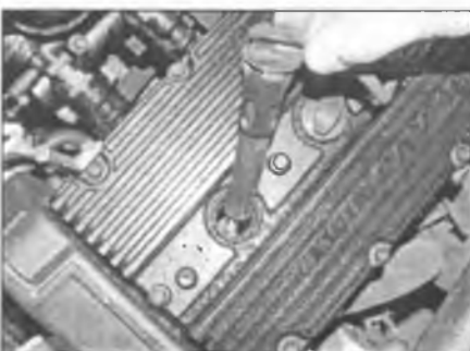
Рис. 32.3. Отсоедините провода высокого напряжения; при этом следует тянуть за наконечник, а не за провод
