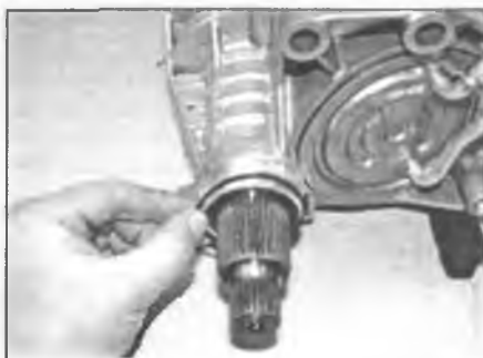
Рис. 5.14. Смажьте новое уплотнительное кольцо чистым маслом и установите его на горловину раздаточной коробки
