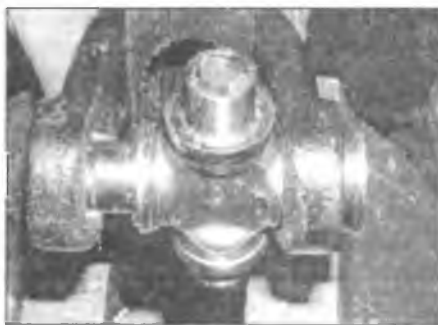
Рис. 7.32. Частично вставьте наружное кольцо одного из подшипников в вилку и введите крестовину в наружное кольцо подшипника
