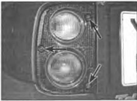
Рис. 5.21. Выверните три винта крепления блока задних фонарей (отмечены стрелками)
