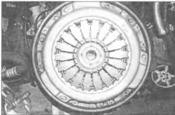
Рис. 6.3. Работая в перекрестной последовательности, отпустите болты нажимного диска (по пол-оборота за раз)
