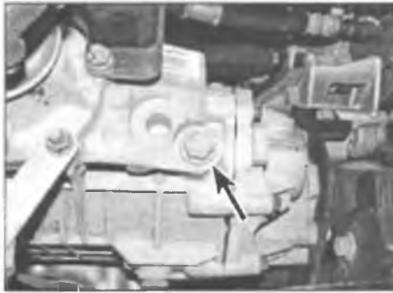
Рис. 2.3. Пробка заливного/ контрольного отверстия располагается на правой задней стенке раздаточной коробки (отмечена стрелкой)
