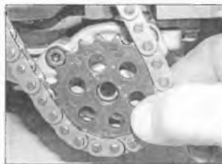
Рис. 9.8. Ориентируясь по лыске, установите звездочку на приводной вал масляного насоса
