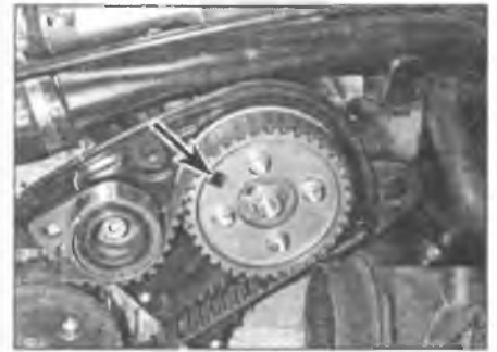
Рис. 8.6,а. Чтобы придержать звездочку, вставьте ключ с храповым механизмом или подходящий ключ на 3/8 дюйма в квадратное отверстие (отмечено стрелкой) ...
