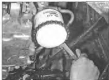
Рис. 3.8. При необходимости для отпускания фильтра используйте соответствующий съемник
