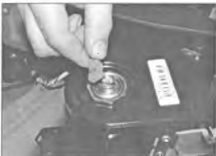
Рис. 23.10. Рассоедините электрический разъем подушки безопасности
