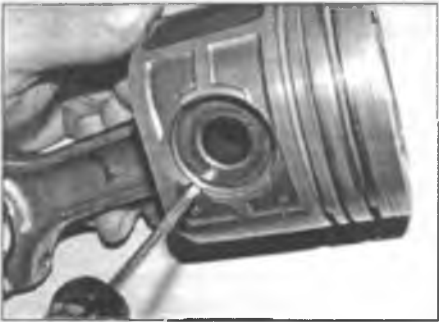
Рис. 15.33. С помощью маленькой отвертки снимите стопорные кольца с поршня
