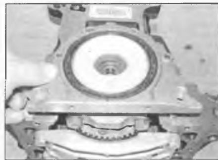
Рис. 12.12. Установите защитную втулку манжеты на конец коленчатого вала и аккуратно установите манжету вместе с корпусом на штатное место
