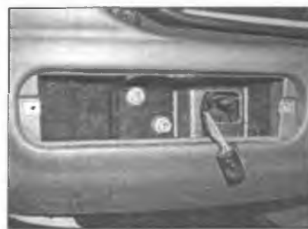
Рис. 7.6. Через отверстия для фонарей, отверните с каждой стороны по две гайки крепления балки бампера к автомобилю
