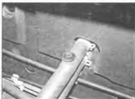
Рис. 29.17. Выверните винт выпуска воздуха из возвратного шланга отопителя около перегородки моторного отделения
