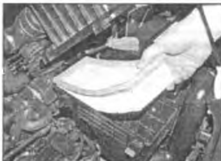
Рис. 25.4. Правильно установите фильтрующий элемент воздухоочистителя
