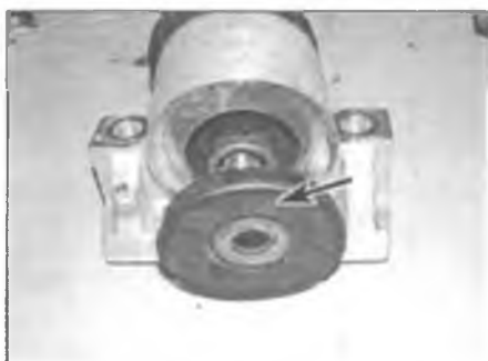
Рис. 3.10. Обратите внимание на маркировку OUT (НАРУЖУ) на внешней стороне большой демпферной шайбы
