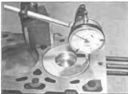
Рис. 13.26. Чтобы определить толщину прокладки головки цилиндров, измерьте выступание каждого поршня – см. текст
