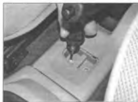
Рис. 28.15,а. Отпустите винты консоли спереди и сзади
