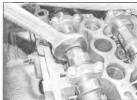
Рис. 6.5.а. Возьмитесь гаечным ключом за шестигранную шейку выпускного распределительного вала, слегка проверните вал по часовой стрелке
