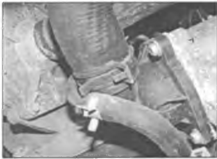
Рис. 4.11. Отпустите хомут и отсоедините шланг охлаждающей жидкости от крышки термостата
