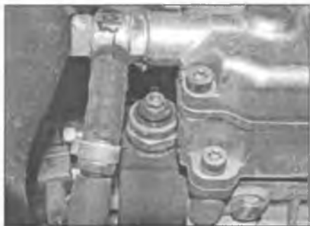
Рис. 12.40. Отверните гайку и отсоедините провод от клеммы электромагнитного клапана отсечки топлива
