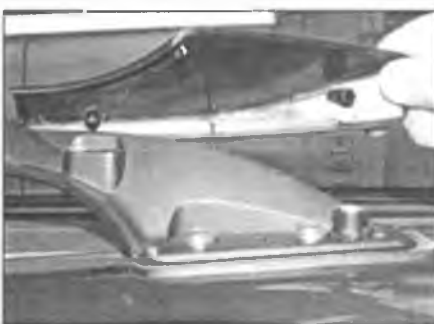
Рис. 24.4. Снимите крышки на переднем и заднем концах дуг. Это даст доступ к болтам
