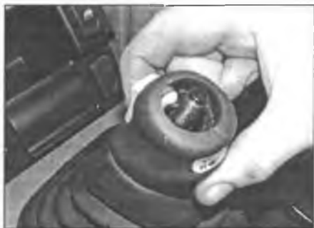
Рис. 3.10. Не перетяните рукоятку рычага переключения передач. Торец рукоятки должен оставаться заподлицо с переключателем системы контролируемого спуска
