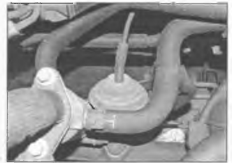
Рис. 3.14. Отсоедините вакуумный шланг от клапана рециркуляции – двигатель серии "L"
