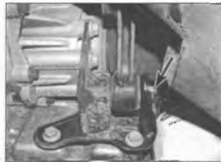
Рис. 8.37,а. Выверните болт (отмечен стрелкой) и отсоедините нижнюю стяжку двигателя от поддона ...
