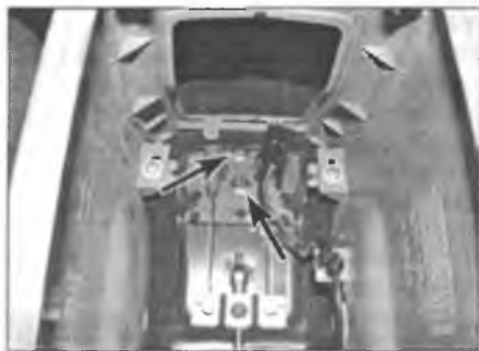
Рис. 28.21,а. Выверните два винта из задней части консоли, ...
