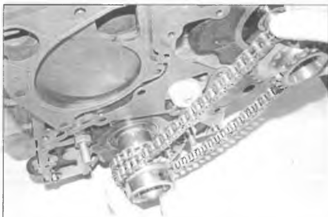
Рис. 8.20. Цепь привода масляного насоса надевается на внутренний ряд зубьев звездочки коленчатого вала, а цепь привода топливного насоса высокого давления надевается на внутренний ряд зубьев звездочки насоса
