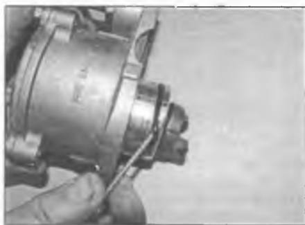
Рис. 18.13. Снимите уплотнительное кольцо и выбросьте его; при установке следует использовать новое
