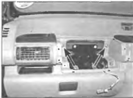
Рис. 29.11, г. ... два в гнезде для подушки безопасности пассажира (отмечены стрелками) или за поручнем лицевой панели, ...
