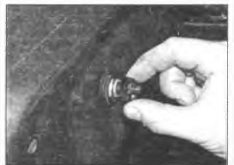
Рис. 17.6. Отверните внутреннюю гайку вала стеклоочистителя и снимите шайбу и резиновое уплотнение
