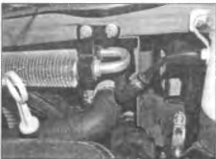
Рис. 6.30. Отверните гайки крепления охладителя топлива
