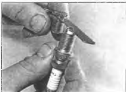
Рис. 32.14,а. Измерьте межэлектродный зазор, используя плоский щуп ...
