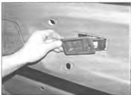
Рис. 12.4,б. ... затем высвободите и снимите коробчатую панель ручки открывания двери
