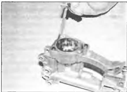
Рис. 10.5. Измерьте зазор между наружным ротором и корпусом
