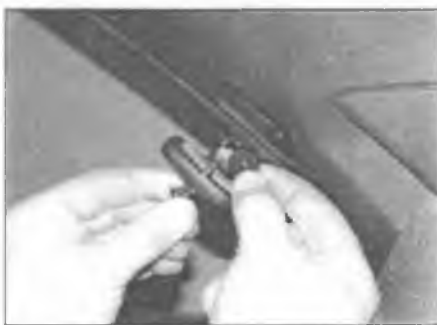
Рис. 19.3,б. ... и высвободите защелку из задней стойки. Не забудьте про дистанционный элемент
