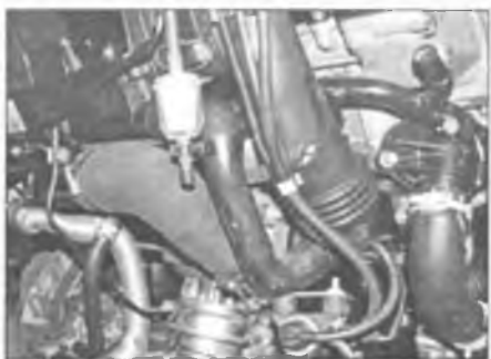
Рис. 12.32. Высвободите вакуумный шланг и жгут электропроводки из зажима на воздуховоде турбокомпрессора
