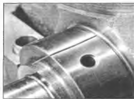
Рис. 20.13. Положите нить Plastigauge на шейку параллельно оси коленчатого вала
