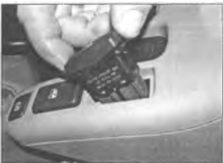
Рис. 4.47. При снятой консоли для снятия соответствующего переключателя подтолкните его сзади
