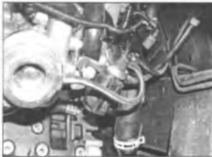
Рис. 3.19. Отсоедините вакуумный шланг от клапана рециркуляции – двигатель TD4
