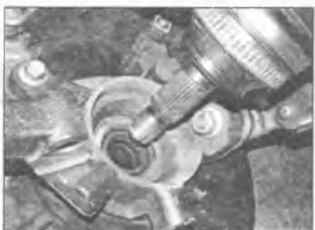
Рис. 2.16. Вставьте полуось в ступицу
