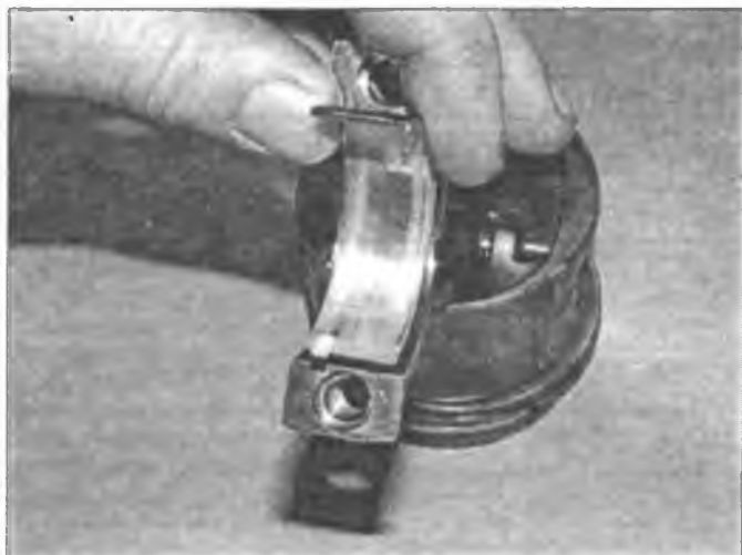
Рис. 21.40.б. Обеспечьте, чтобы выступ на каждом вкладыше вошел в паз в крышке подшипника и в шатуне
