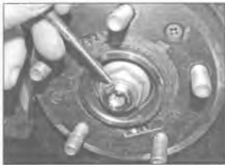
Рис. 2.21. Закерните выступ гайки в канавку на конце полуоси
