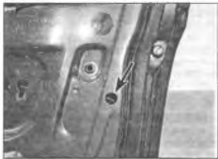
Рис. 13.8,б. Выньте уплотнительную втулку, через отверстие (отмечено стрелкой) выверните болт наружной ручки двери
