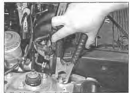
4 Подсоедините другой конец чёрного провода к какому-нибудь чистому болту или кронштейну на блоке цилиндров запускаемого двигателя, подальше от аккумулятора.
