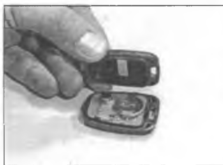
Рис. 30.2.б. ... и подденьте крышку
