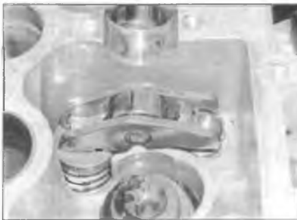
Рис. 6.18. Установите клапанные рычаги
