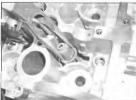
Рис. 9.3,б. Аккуратно снимите маслоотражательный колпачок с направляющей втулки клапана
