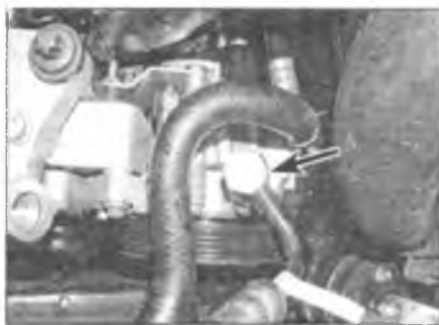
Рис. 20.32. Выверните болт штуцерного соединения типа "банджо" (отмечен стрелкой), отсоедините шланг и снимите уплотнительные шайбы
