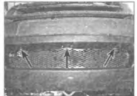
Рис. 6.9. Извлеките три фиксатора в центральной выемке ниже номерного знака (отмечены стрелками)
