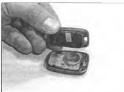
Рис. 28.2.б. ... и подденьте крышку
