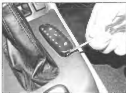
Рис. 4.1. Аккуратно подденьте и извлеките указатель из панели отделки рычага селектора
