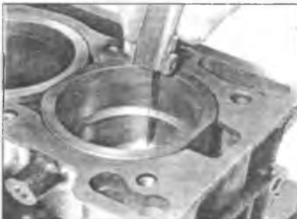
Рис. 19.4. Расположите поршневое кольцо, как описано в тексте, и с помощью щупа измерьте зазор в замке
