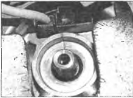
Рис. 14.5. Нанесите отметки взаиморасположения на ступицу рулевого колеса и верхний торец рулевого вала, обеспечивая установку колеса в исходное положение
