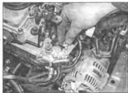
Рис. 13.10. Выверните болт крепления трубки указателя уровня масла
