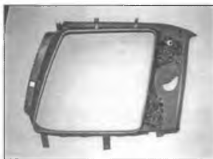
Рис. 27.23. Теперь обрамление удерживается восемью фиксаторами по двум сторонам и верхнему краю панели
