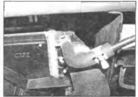
Рис. 3.3. Отсоедините шланг расширительного бачка от выпускного патрубка
