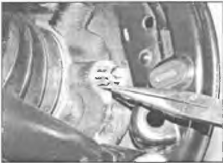
Рис. 20.29. Извлеките втулку датчика АБС
