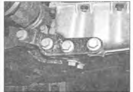
Рис. 8.14. Выверните три болта и снимите кронштейн нижней стяжки с поддона двигателя
