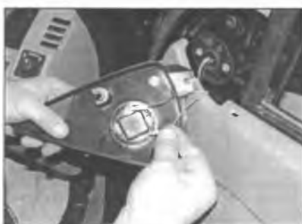
Рис. 12.2. Рассоедините электрические разъемы высокочастотных динамиков, расположенные внутри панели отделки зеркала
