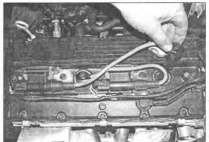
Рис. 3.6. Отсоедините провода высокого напряжения; тяните за наконечник, а не за провод
