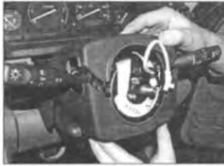
Рис. 15.2. Верхний кожух фиксаторами прикреплен к нижнему кожуху (рулевое колесо для наглядности снято)
