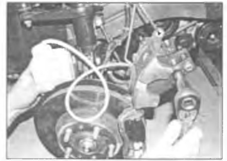
Рис. 4.7. Открывайте винт выпуска воздуха по мере вдавливания поршня
