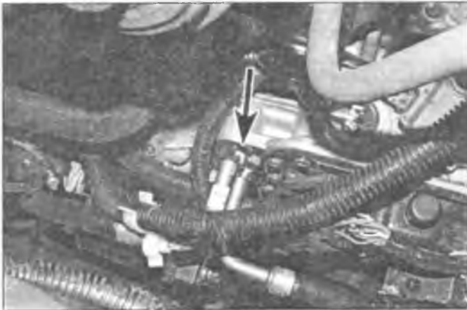
Рис. 8.3. Отпустите соединения (отмечены стрелками) и отсоедините шланги трансмиссионной жидкости от радиатора
