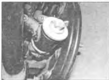
Рис. 10.2. Отверните гайку и извлеките болт крепления наружного конца рычага к опоре ступицы
