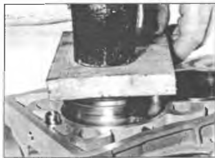
Рис. 14.21. Легко постукивая молотком через деревянный брусок, полностью вставьте гильзу на место; буртик гильзы должен сесть на соответствующий упор
