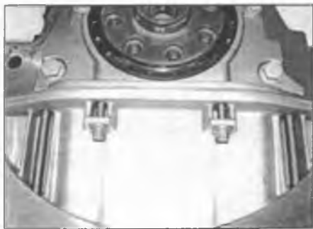
Рис. В.11. Доступ к двум болтам возможен через вырезы в маховике
