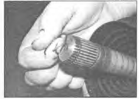
Рис. 4.5,б. Проверьте стопорное кольцо на наличие повреждений и при необходимости установите новое
