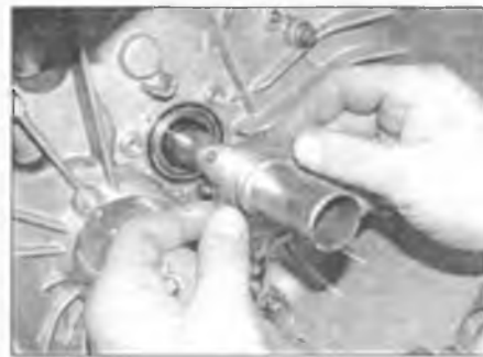
Рис. 4.10,а. Выверните три болта крепления направляющей втулки подшипника выключения сцепления и снимите втулку с первичного вала, ...
