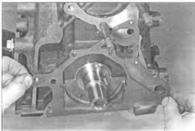
Рис. 15.10. Установите новую прокладку, ориентируясь на установочные штифты
