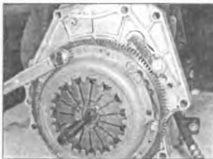
Рис. 6.18. Сцентрируйте ведомый диск, а потом постепенно затяните болты нажимного диска предписанным усилием затяжки
