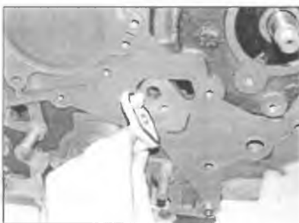
Рис. 7.10. Выверните болт и снимите форсунку смазки цепи
