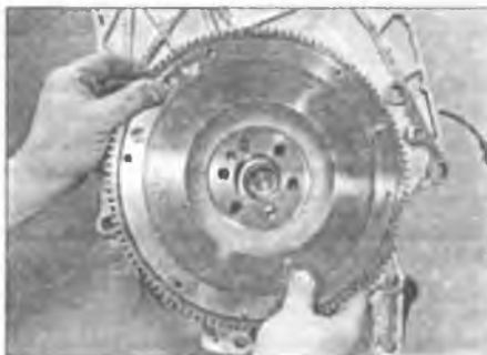
Рис. 19.4. Осторожно снимите маховик, не уроните его
