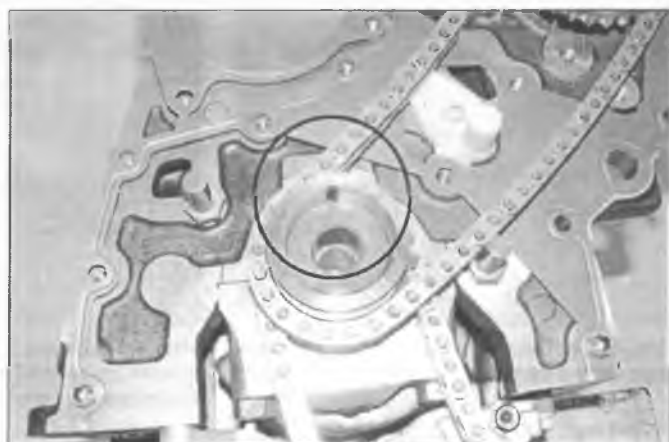
Рис. 8.21. Совместите шпоночный паз в звездочке со шпонкой на коленчатом валу
