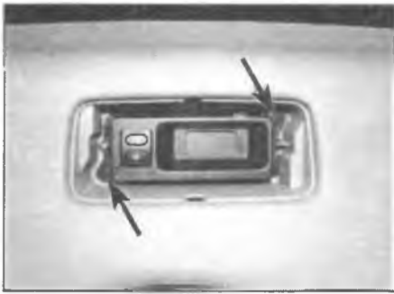
Рис. 11.2. Выверните два винта крепления часов (отмечены стрелками) и извлеките часы из гнезда на лицевой панели
