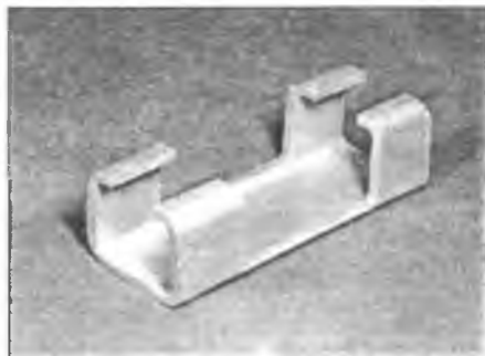
Рис. 7.6,а. Инструмент для стопорения звездочки можно сделать из профиля с коробчатым сечением
