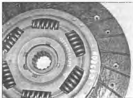
Рис. 6.14,в. Ведомый диск должен быть снабжен маркировкой GETRIEBESEITE (сторона коробки передач), которая должна быть обращена в сторону от маховика...
