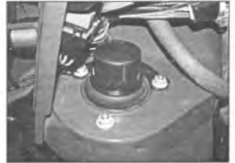
Рис. 9.11. Отпустите гайки верхнего крепления стойки
