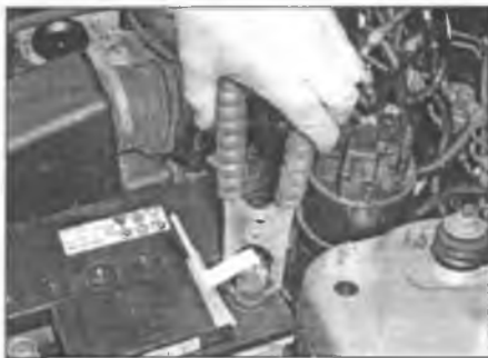
1 Подсоедините один конец красного провода "прикуривателя" к клемме "+" разряженного аккумулятора.
