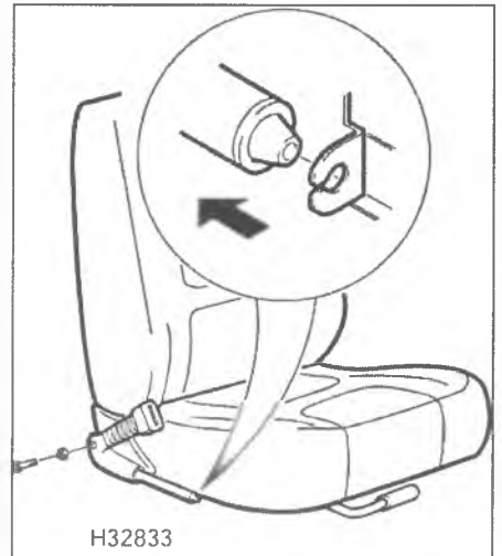
Рис. 26.15. Выверните болт (с шайбой) из преднатяжителя ремня безопасности
