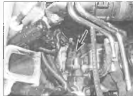
Рис. 12.92 Регулятор давления топлива, расположенный на конце топливного насоса (отмечен стрелкой)
