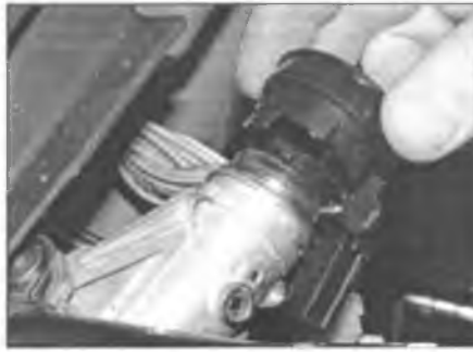
Рис. 29.5. Сдвиньте катушку приемопередатчика иммобилайзера (при наличии) с цилиндра выключателя зажигания
