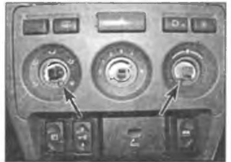
Рис. 4.34. Снимите три ручки управления отопителем и выверните скрытые под ними два винта (отмечены стрелками)
