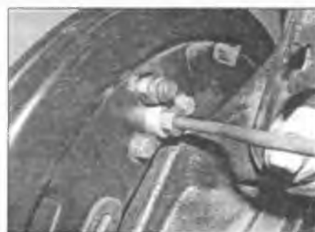
Рис. 10.3. Вытрите грязь вокруг штуцера тормозного трубопровода на задней стороне колесного цилиндра и отверните гайку
