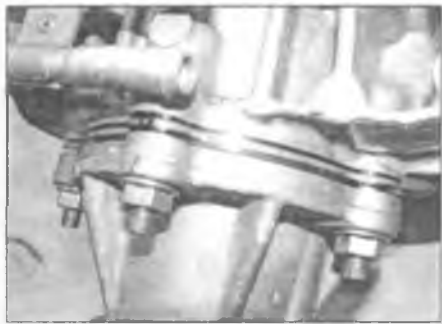
Рис. 4.4. Отверните пять болтовых соединений стыка корпуса шестерни заднего привода с главной секцией картера
