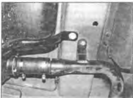
Рис. 3.11. Выверните болт крепления кронштейна заливной горловины
