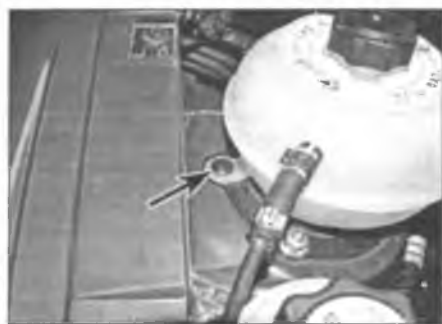
Рис. 3.39. Выверните винт крепления расширительного бачка (отмечен стрелкой)
