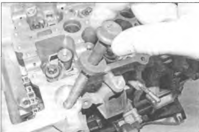
Рис. 7.39. Самый короткий болт (с внутренним шестигранником) следует установить в позицию 11
