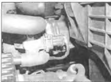
В Проверьте крепление электропроводки системы впрыска топлива.
