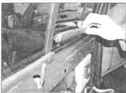
Рис. 14.6. Аккуратно снимите уплотнитель окна с рамы двери и с заднего края направляющего желоба
