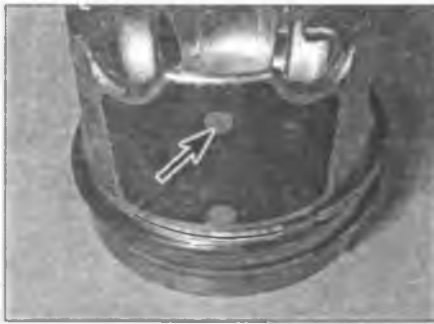
Рис. 15.17. Измерьте диаметр поршня в зоне кружков, оставленных открытыми на графитовом покрытии (отмечены стрелкой)
