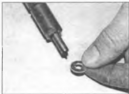
Рис. 11.28. Установите на форсунки новые уплотнительные шайбы
