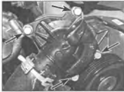
Рис. 4.15. Выверните четыре болта (отмечены стрелками) и снимите корпус термостата
