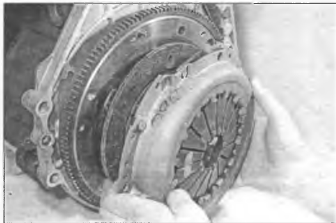
Рис. 6.4. Снимите нажимной и ведомый диски с маховика
