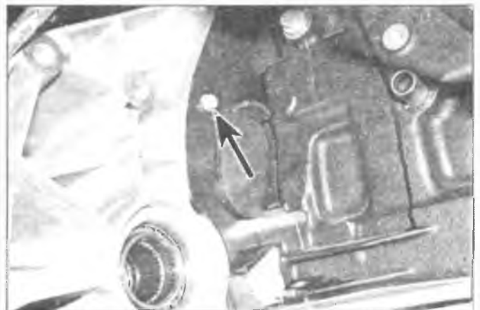
Рис. 8.68. Выверните болт (отмечен стрелкой) из крышки маховика в задней части коробки передач
