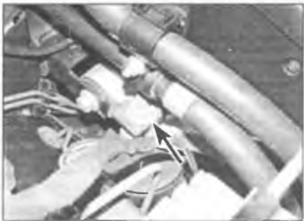
Рис. 4.35. Отверните гайку крепления кронштейна шланга усилителя рулевого управления к правой опоре двигателя (отмечена стрелкой)
