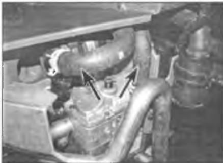
Рис. 9.50. Отсоедините питающий и возвратный шланги охлаждающей жидкости (отмечены стрелками) от отопителя, работающего на топливе
