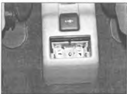
Рис. 28.15,б. Элементы крепления консоли имеют пазы, и поэтому полностью вывинчивать винты не надо
