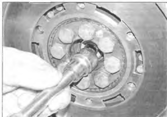
Рис. 15.6. Используйте трубчатую оправку или торцевую головку, которая упирается только в наружный край подшипника
