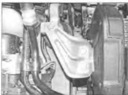
Рис. 17.32. Выверните два болта крепления опорного рычага к двигателю
