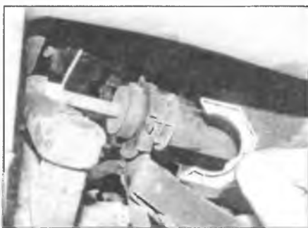
Рис. 7.13. Подденьте и снимите зажим рабочего цилиндра сцепления
