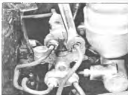
Рис. 3.3. Для отвинчивания гаек штуцерных соединений желательнее использовать специальный гаечный ключ (для тормозных магистралей) надлежащего размера
