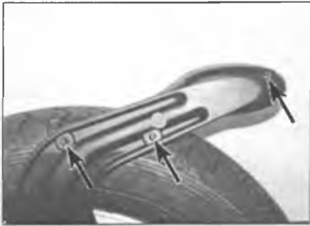
Рис. 5.28. Выверните три винта и отсоедините крышку стоп-сигнала
