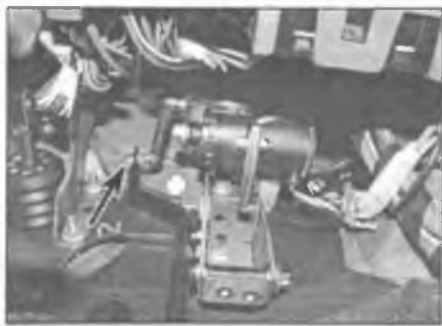
Рис. 4.1. Отверните гайку крепления рычага датчика положения педали к педали акселератора
