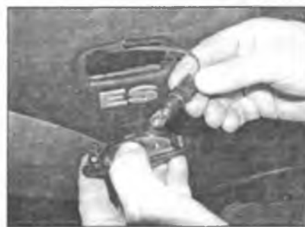
Рис. 5.19,а. Поверните патрон против часовой стрелки, чтобы высвободить его из корпуса указателя, ...
