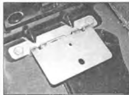
Рис. 9.3. Снимите опорный кронштейн центральной консоли
