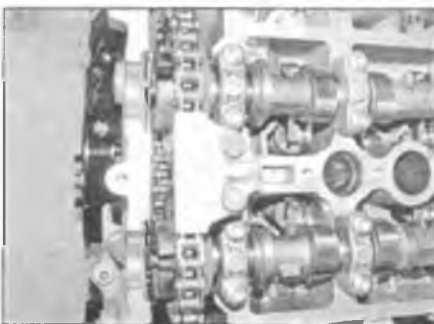
Рис. 6.6. Снимите направляющую подачи масла, расположенную между распределительными валами
