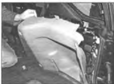
Рис. 27.30. Высвободите и снимите боковую панель отделки багажного отделения
