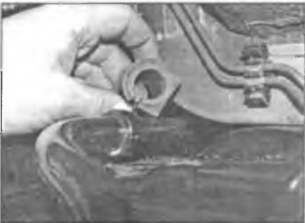
Рис. 5.4. Резиновые втулки имеют разрез и поэтому их можно повернуть и снять со стабилизатора, не снимая последний
