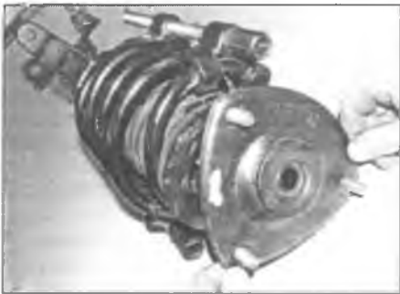
Рис. 2.11,а. Снимите отбойную шайбу и верхнюю опорную пластину, ...
