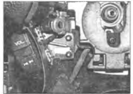
Рис. 4.25. Выверните два винта крепления переключателя и снимите переключатель с рулевого колеса
