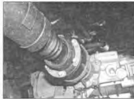
Рис. 5.7. Отметьте положение переднего фланца карданного вала относительно фланца заднего привода
