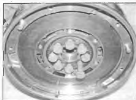
Рис. 13.3. Выверните болты маховика и выбросьте их; при установке следует использовать новые
