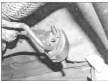
Рис. 11.3. Проверьте, все ли опоры системы выпуска находятся в хорошем состоянии
