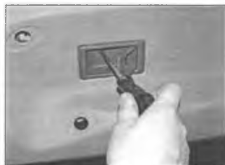
Рис. 12.4,а. Выверните винт, ...
