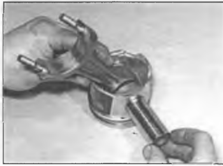
Рис. 15.21,б. ...выпрессуйте поршневой палец и отделите поршень от шатуна
