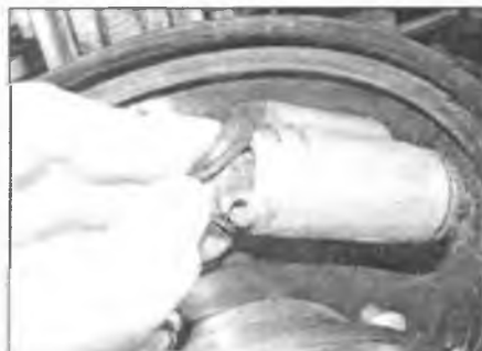
Рис. 27.3. Отогнув резиновые чехлы, проверьте колесные тормозные цилиндры: нет ли признаков протечек тормозной жидкости
