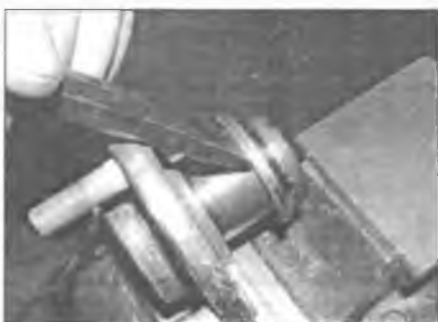
Рис. 4.13. С помощью зубила осторожными ударами постепенно снимите внутреннее кольцо подшипника
