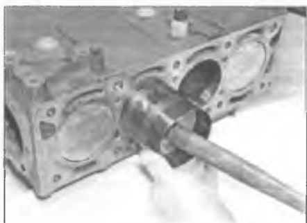
Рис. 21.31. Вставьте поршень в сборе с шатуном в цилиндр и, мягко постукивая ручкой молотка, приведите его в требуемое положение
