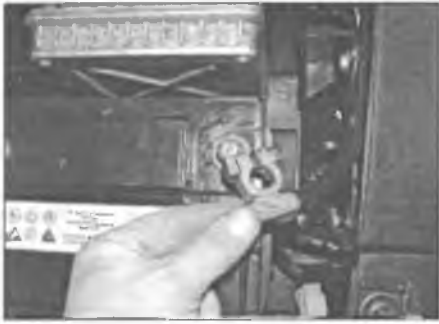
Рис. 4.2. Отпустите гайку зажима и отсоедините провод массы от соответствующей клеммы аккумулятора
