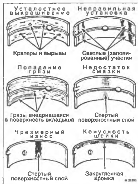
Рис. 17.2. Типичные неисправности вкладышей подшипников
