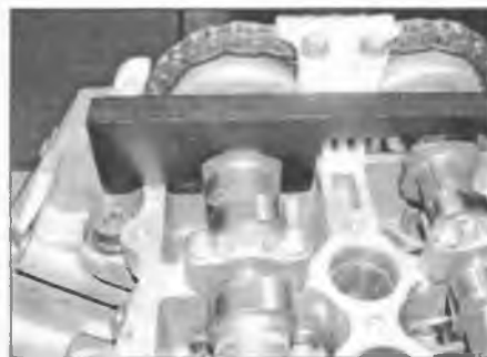
Рис. 6.30. Установите инструмент для проверки положения на квадратную секцию выпускного распределительного вала
