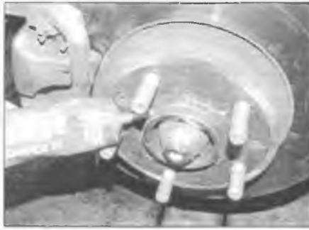
Рис. 16.2. Нанесите тонкий слой консистентной смазки на поверхность контакта колеса со ступицей
