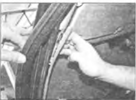
Рис. 27.6,а. Снимите резиновый уплотнитель двери, примыкающий к панели отделки. Аккуратно отделите панель от передней стойки
