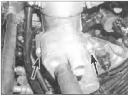
Рис. 11.5,а. Выверните три болта (отмечены стрелками, один закрыт маслоохладителем)
