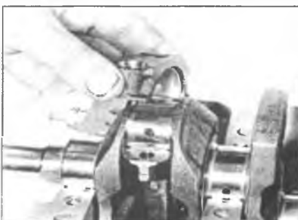
Рис. 13.5. Снимите крышку подшипника и вкладыш нижней головки шатуна цилиндра №1
