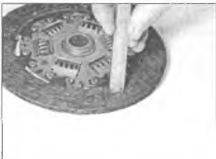
Рис. 6.7. С помощью штангенциркуля измерьте заглабление головки заклепки относительно фрикционного материала
