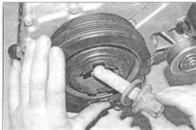
Рис. 5.6,а. Выверните болт и уберите его вместе с шайбой...
