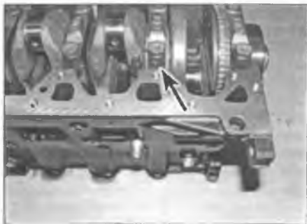
Рис. 20.74. Идентификационный номер крышки подшипника (отмечен стрелкой) находится на задней стороне блока цилиндров (со стороны турбокомпрессора)
