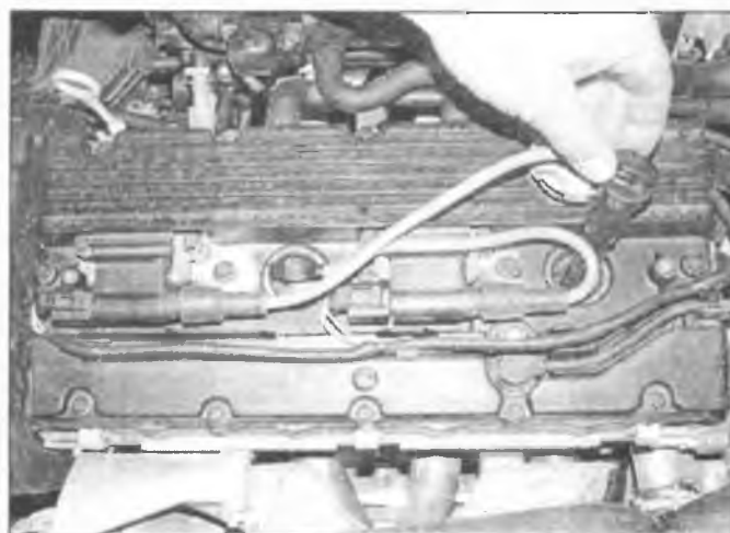
Рис. 32.6. Отсоедините провода высокого напряжения; при этом следует тянуть за наконечник, а не за провод
