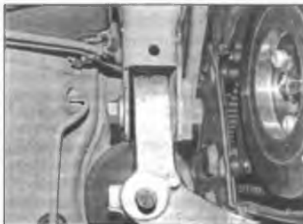
Рис. 5.30. Выверните болт крепления верхней стяжки к правой опоре двигателя
