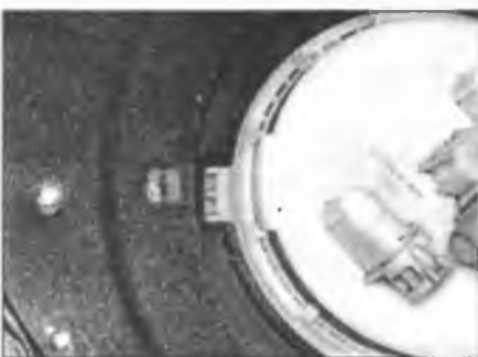
Рис. 8.17. Установочный выступ насоса должен войти в паз в баке
