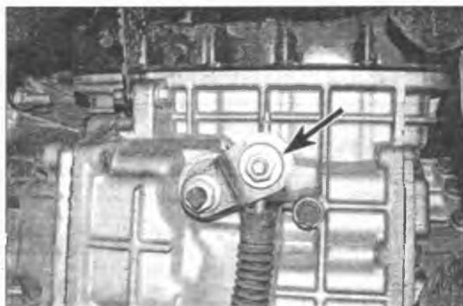
Рис. 3.5.а. Отпустите гайку зажима троса селектора (отмечена стрелкой) со стороны коробки передач ...
