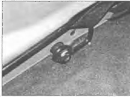
Рис. 26.3. Болт нижней непрвляющей крепления ремня безопасности переднего сиденья
