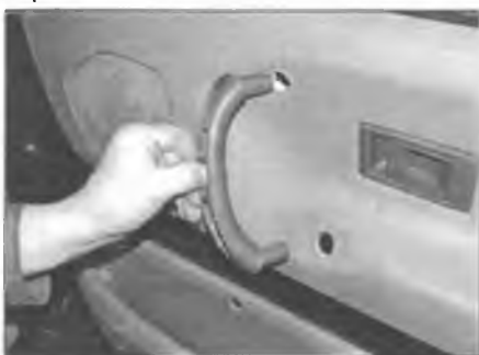
Рис. 12.3,в ... и снимите поручень
