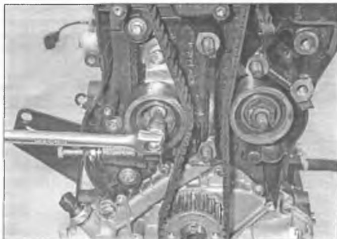
Рис. 7.26. Отведите шкив в сторону от ремня газораспределительного механизма и зафиксируйте его, слегка затянув болт
