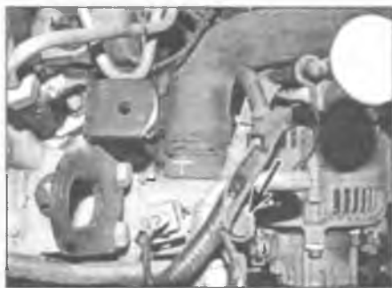
Рис. 3.6. Выверните болт крепления направляющей трубки указателя уровня (отмечен стрелкой)
