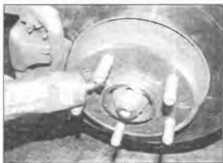
Рис. 15.2. Нанесите тонкий слой консистентной смазки на поверхность контакта колеса со ступицей
