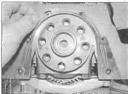
Рис. 12.11. Установите новую прокладку, ориентируясь на установочные штифты
