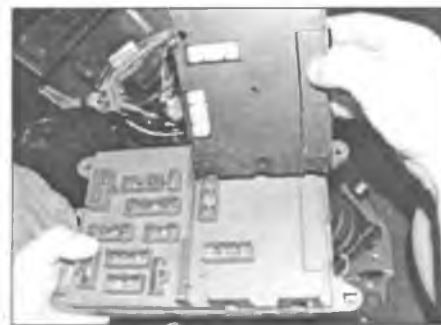
Рис. 24.7. Отделите центральный блок управления от коробки плавких предохранителей
