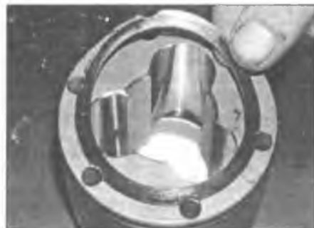
Рис. 7.12. Снимите и выбросьте уплотнение, установленное между корпусом шарнира и "жестяжкой"
