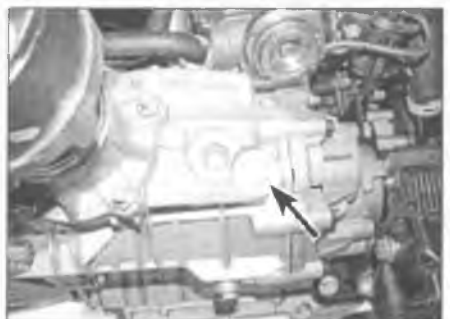
Рис. 10.2. Пробка заливного/ контрольного отверстия раздаточной коробки (отмечена стрелкой)
