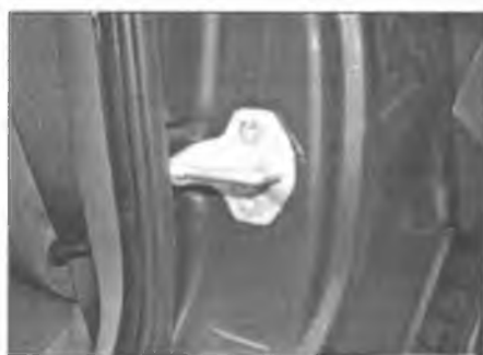
Рис. 11.18. Чтобы отрегулировать положение ответной части замка двери, отпустите винты
