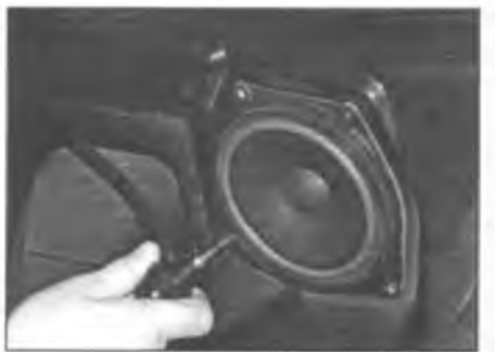
Рис. 20.5,а. Выверните четыре винта динамика, ...
