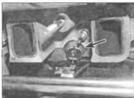
Рис. 7.8. Рассоедините электрический разъем и выверните датчик (отмечен стрелкой) – дизельный двигатель TD4
