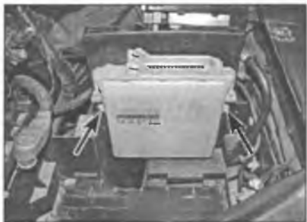
Рис. 12.47 Отверните четыре гайки/ болта крепления БЭУ (отмечены стрелками)
