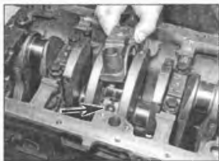
Рис. 13.13. Снимите крышки коренных подшипников, обращая внимание на установочные штифты (один отмечен стрелкой)
