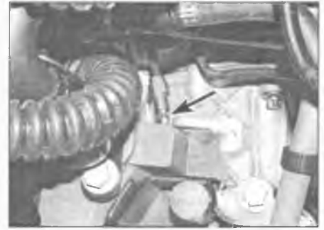
Рис. 5.3. Проверьте, закрыт ли винт выпуска воздуха на рабочем цилиндре (отмечен стрелкой)
