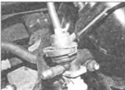
Рис. 13.4. Отпустите хомут и отсоедините вакуумный трубопровод от гасителя пульсаций давления топлива
