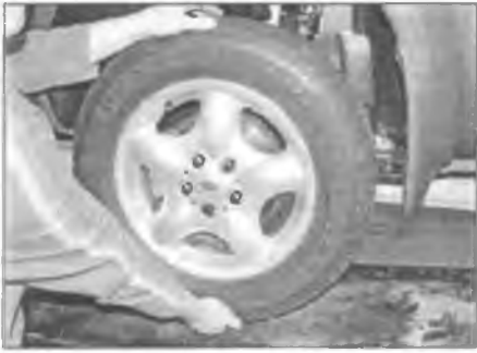
Рис. 15.4. Возьмитесь за колесо сверху и снизу и попытайтесь покачать его
