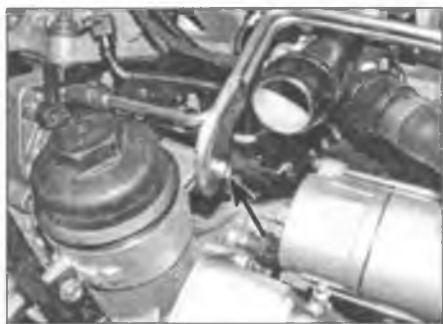
Рис. 10.50. Выверните болт крепления кронштейна топливопровода к корпусу масляного фильтра (отмечен стрелкой)
