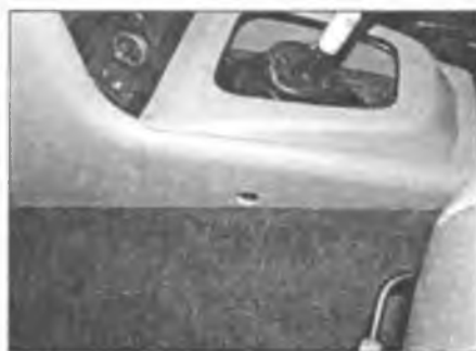
Рис. 28.10,б. ... и двумя винтами с каждой стороны в основании консоли
