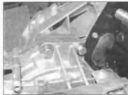
Рис. 5.96. Выверните болты крепления раздаточной коробки – два сверху и два снизу
