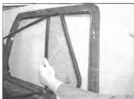
Рис. 14.10. Аккуратно потяните верхушку форточка вместе с уплотнителем в направлении передней части рамы двери и снимите с автомобиля
