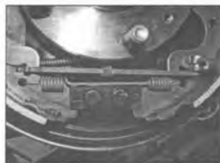
Рис. 5.24. Установите нижнюю возвратную пружину и планку стояночного тормоза
