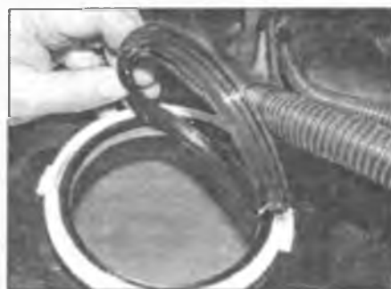
Рис. 7.10. Установите новое уплотнительное кольцо на бак
