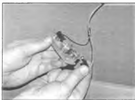
Рис. 27.26,б. ... и разъедините электрические разъемы
