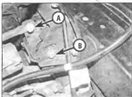
Рис. 7.14. Выверните болт опорной штанги (А) и анкерный болт крепления опоры к кронштейну (В)
