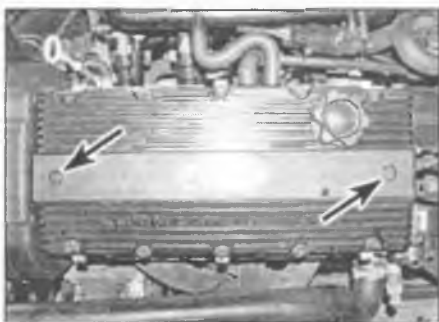
Рис. 32.2. Выверните винты (отмечены стрелками) и снимите крышку свечей зажигания
