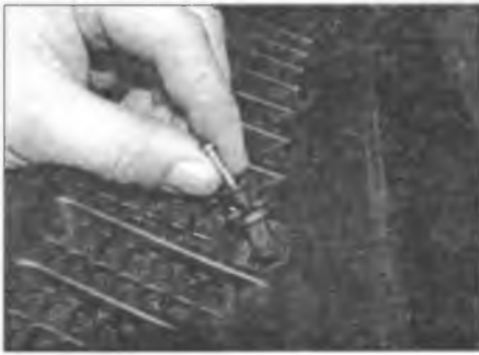
Рис. 16.3,а. Для извлечения заднего ряда фиксаторов извлеките сначала центральную секцию фиксатора (используя винт), а за ней наружную секцию
