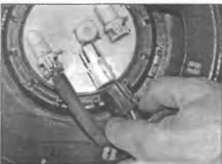
Рис. 8.5. Рассоедините электрический разъем топливного насоса
