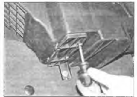
Рис. 24.1,б. На вариантах начиная с 2001 модельного года пылевой фильтр крепится четырьмя винтами
