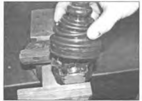
Рис. 4.16. Установите новый чехол на полуось
