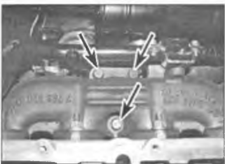
Рис. 19.45. Выверните три болта крепления турбокомпрессора к выпускному коллектору (отмечены стрелками)
