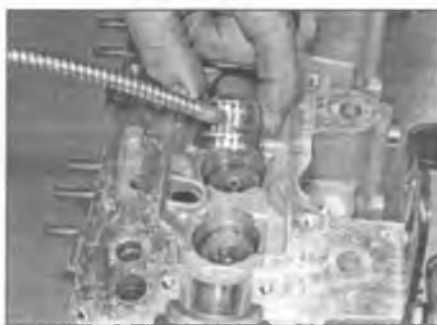
Рис. 12.11. Смажьте толкатели чистым моторным маслом и вставьте их в исходные отверстия
