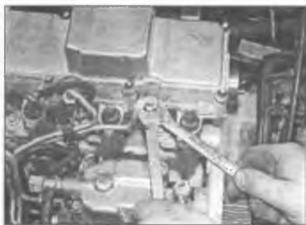
Рис. 11.5. Придержите форсунку и отверните гайку штуцерного соединения топливопровода форсунки
