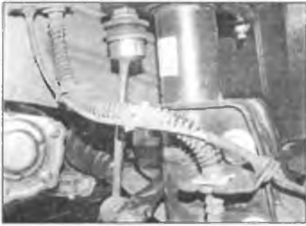
Рис. 23.2. Проверьте правильность разводки и надежность крепления жгутов электропроводки датчиков скорости колес
