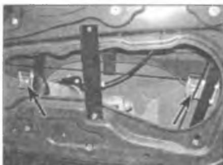
Рис. 14.3. Зажимные болты стекла окна передней двери
