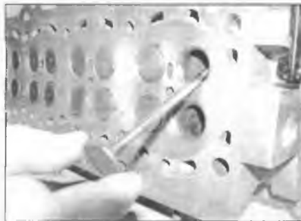
Рис. 11.1. Установите клапаны на свои штатные места
