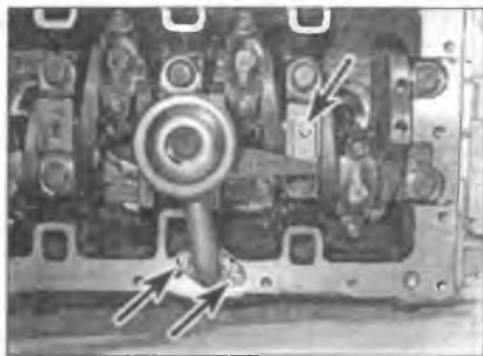
Рис. 14.10. Выверните болты (отмечены стрелками) и снимите маслозаборник/сетчатый фильтр масляного насоса
