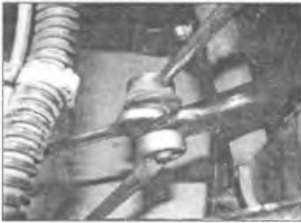
Рис. 6.2. Придержите палец шарового шарнира стойки стабилизатора от проворачивания вторым гаечным ключом с внутренней стороны штанги стабилизатора
