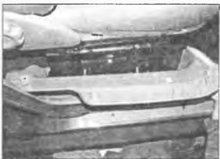
Рис. 25.2,а. Снимите боковую облицовочную панель подушки сиденья
