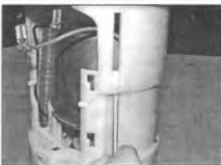
Рис. 8.10. Высвободите три выступа из пазов и разделите две секции насоса
