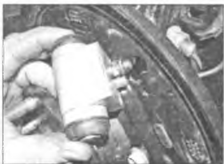
Рис. 10.5. Снимите колесный цилиндр с автомобиля и тщательно очистите его
