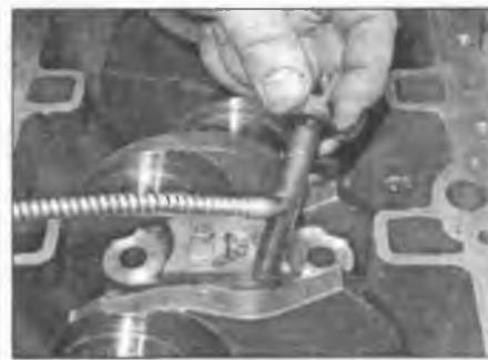
Рис. 20.52. До установки болтов крышек коренных подшипников смажьте их резьбу и нижнюю сторону головок маслом
