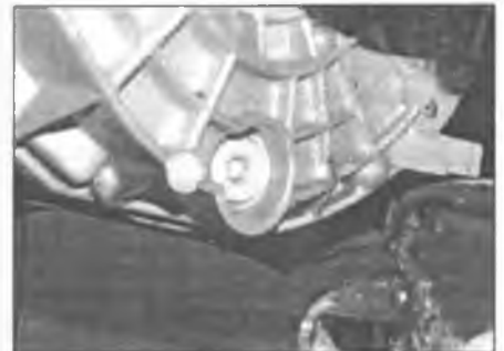
Рис. 2.5. Выверните сливную пробку и дайте стечь маслу
