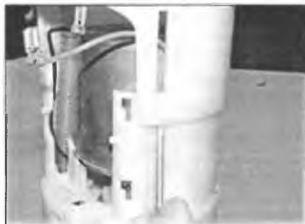
Рис. 33.3,а. Для отпускания зажимов и разделения секций насоса используйте маленькую отвертку
