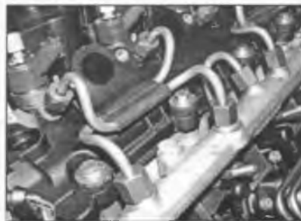
Рис. 11.20. Отпустите зажимы и отпустите штуцерные соединения топливопроводов
