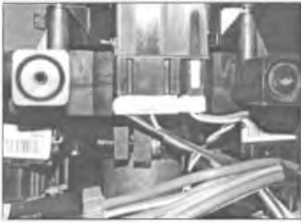
Рис. 23.24. Разъем контакта должен быть наверху
