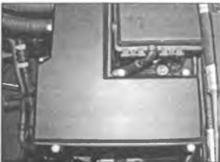
Рис. 12.50 Выверните пять винтов (с внутренним шестигранником) и снимите крышку электромонтажной коробки
