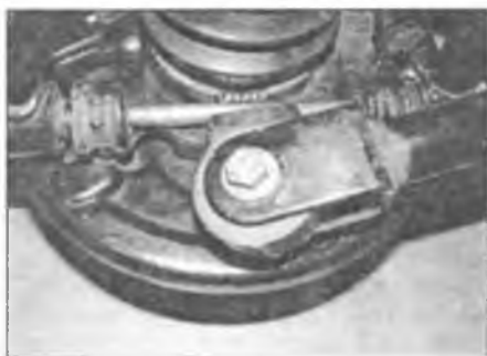
Рис. 10.8. Отверните гайку и извлеките болт крепления наружного конца рычага к опоре ступицы
