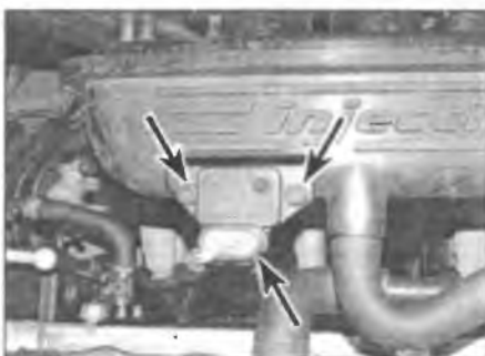
Рис. 13.32. Рассоедините электрический разъем датчика MAP и выверните два винта
