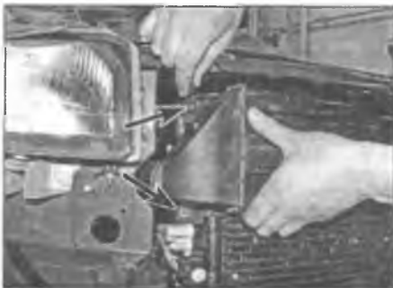
Рис. 3.23. Выверните болты (два отмечены стрелками, один не виден) и снимите промежуточный теплообменник
