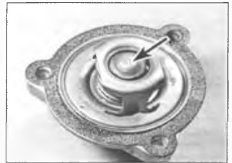
Рис. 4.19. Температура открывания термостата обычно выбита на его торце
