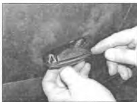
Рис. 5.18. Аккуратно отожмите повторитель в направлении передка автомобиля, отцепите его сзади и извлеките из крыла
