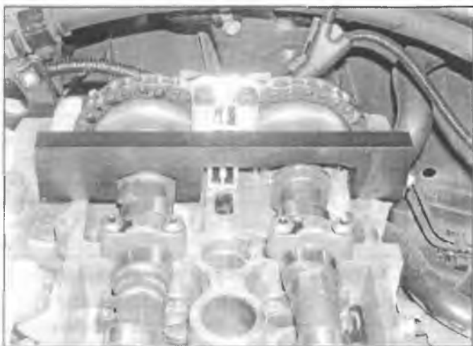
Рис. 3.8,б. Если распределительный вал выставлен правильно, инструмент будет с обеих сторон контактировать с поверхностью под прокладку крышки головки цилиндров (на головке цилиндров)
