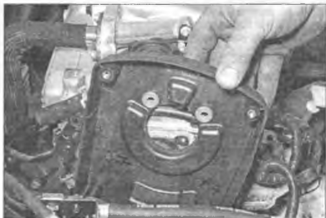
Рис. 6.18,б. ...и снимите заднюю верхнюю крышку
