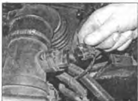
Рис. 12.5. Рассоедините электрический разъем датчика расхода воздуха
