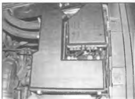
Рис. 4.1В,а. Электрораспределительная коробка моторного отделения
