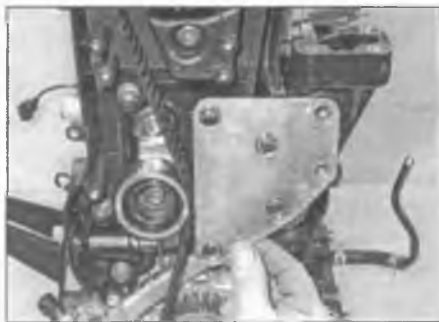
Рис. 7.22. Отверните гайки, выверните болты и снимите крышку с правого опорного кронштейна
