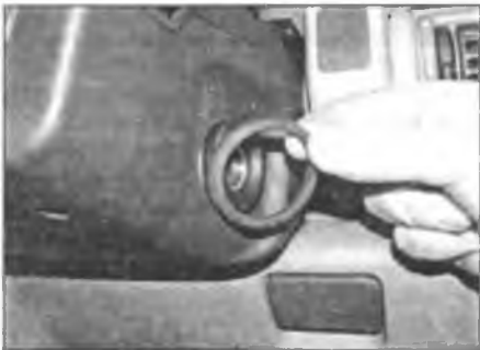
Рис. 15.4. Снимите крышку с замка зажигания
