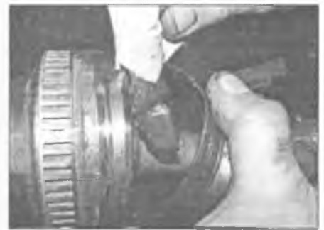
Рис. 4.10. Остаток смазки заправьте в чехол
