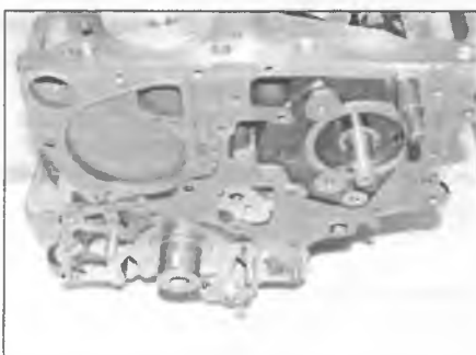
Рис. 7.13. Установите новую прокладку крышки газораспределительного механизма на блок цилиндров
