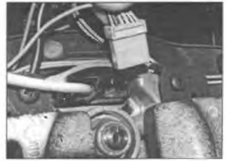
Рис. 14.3. Рассоедините электрический разъем скользящего контакта подушки безопасности
