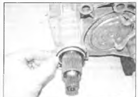
Рис. 4.50. Выбросьте уплотнительное кольцо первичного вала раздаточной коробки; при установке следует использовать новое
