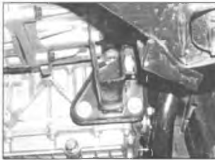
Рис. 5.12,а. Снимите опорный кронштейн раздаточной коробки
