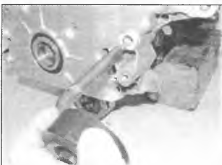
Рис. 7.6, а. Отверните гайку, снимите рычаг натяжителя ремня привода вспомогательных агрегатов...
