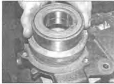
Рис. 4.17. Запрессуйте новый подшипник в поворотный кулак
