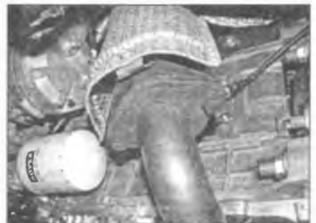
Рис. 15.9. Отверните гайки/ выверните болты и снимите теплозащитный экран выпускного коллектора
