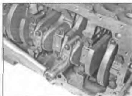
Рис. 21.33. После этого установите крышку подшипника и равномерно и постепенно затяните гайки предписанным усилием
