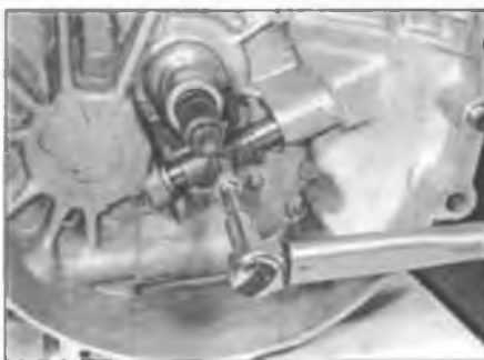
Рис. 7.11. Вверните болт с шайбой и затяните его предписанным усилием
