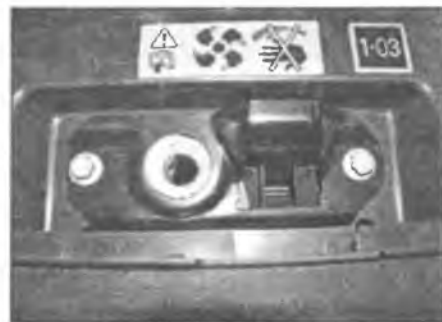
Рис. 10.5. Выверните два болта и снимите верхнюю пластину замка капота
