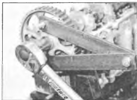
Рис. 8.3. Для удерживания звездочки распределительного вала используйте инструмент, сделанный своими руками
