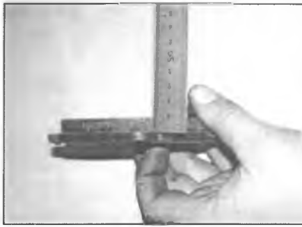
Рис. 4.4. Измерьте остаточную толщину фрикционной накладки на каждой тормозной колодке
