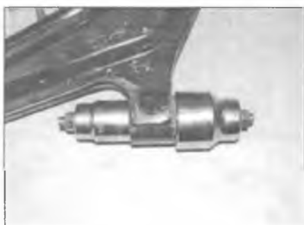
Рис. 3.12. Для извлечения втулки сделайте собственный съемник, используя болт, несколько больших шайб и большие торцевые головки
