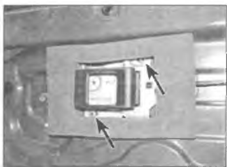
Рис. 13.2. Высверлите две заклепки (отмечены стрелками) крепления ручки к двери
