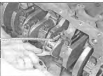
Рис. 21.32. Смажьте шатунную шейку...
