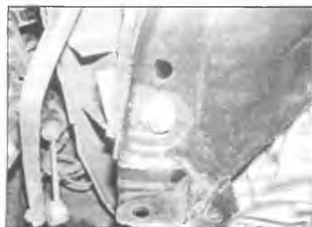
Рис. 5.79. Передний болт крепления подрамника
