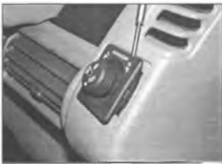
Рис. 4.42. Аккуратно подденьте переключатель и выньте его из гнезда. Будьте осторожны, чтобы не повредить лицевую панель
