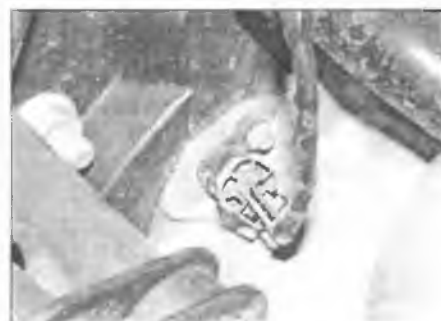
Рис. 13.36. Датчик положения коленчатого вала располагается слева на тыльной стороне двигателя
