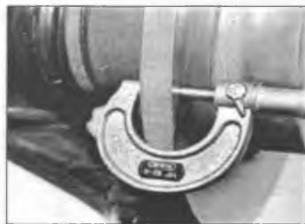
Рис. 6.3. Измерьте толщину диска с помощью микрометра
