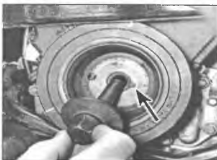
Рис. 5.8. Убедитесь, что паз на шкиве коленчатого вала правильно сцеплен с выступом звездочки (отмечен стрелкой), а затем установите на место болт и шайбу
