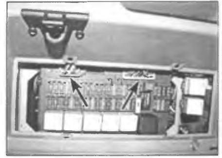
Рис. 29.6. Рассоедините два электрических разъема (отмечены стрелками) коробки плавких предохранителей
