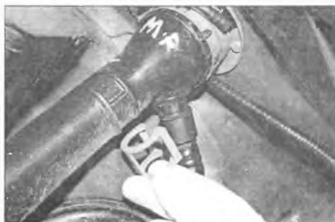
Рис. 3.9,а. Отсоедините два вентиляционных шланга от заливной горловины
