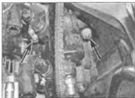
Рис. 10.55. Отверните три гайки (две отмечены стрелками, одна не видна) и снимите топливный насос
