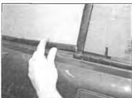
Рис. 14.9. Снимите наружный уплотнитель с рамы двери
