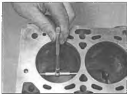
Рис. 14.26. Измерьте диаметр цилиндра с помощью микрометра для измерения внутренних размеров
