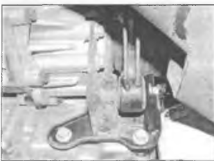
Рис. 5.6. Выверните болт крепления нижней стяжки к кронштейну двигателя
