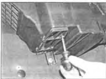
Рис. 23.1,б. На вариантах начиная с 2001 модельного года пылевой фильтр крепится четырьмя винтами
