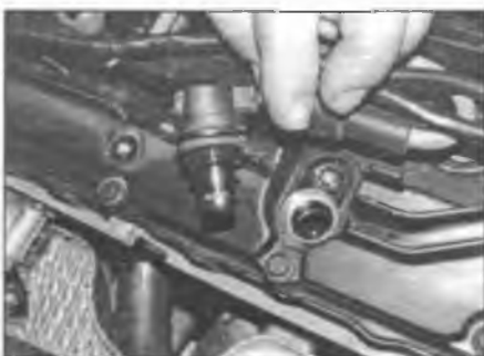
Рис. 13.53. Выверните болт, снимите датчик положения распределительного вала
