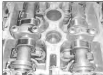
Рис. 6.19,а. Расположите валы так, чтобы кулачки распределительных валов для цилиндра №1 были обращены вверх
