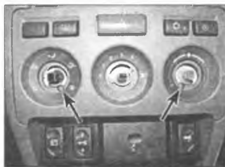
Рис. 28.6. Выверните винты крепления отделки панели управления отопителем (отмечены стрелками)
