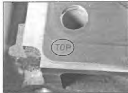
Рис. 13.32. ...и установите новую прокладку, проследив за тем, чтобы она была обращена вверх правильной стороной
