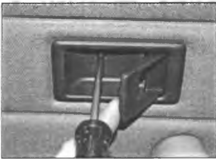
Рис. 12.9. Выверните винт крепления коробчатой панели
