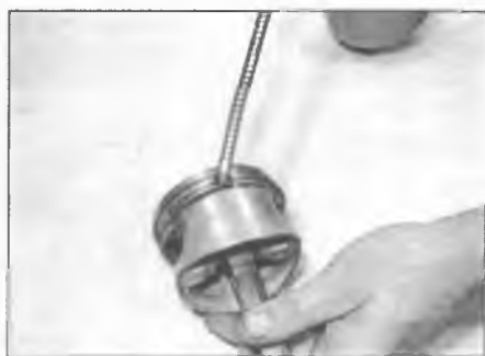
Рис. 21.28. Смажьте поршневые кольца чистым моторным маслом
