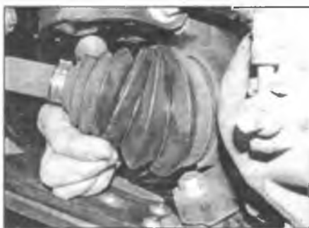
Рис. 16.1. Проверьте состояние резиновых чехлов наружных шарниров равных угловых скоростей
