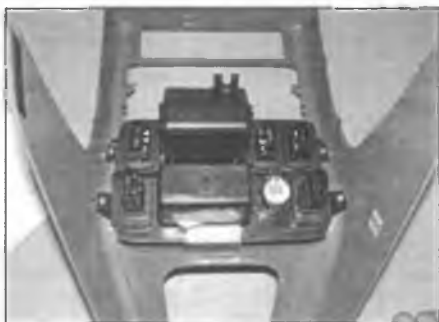
Рис. 4.50. Переключатели на центральной консоли выталкиваются снизу
