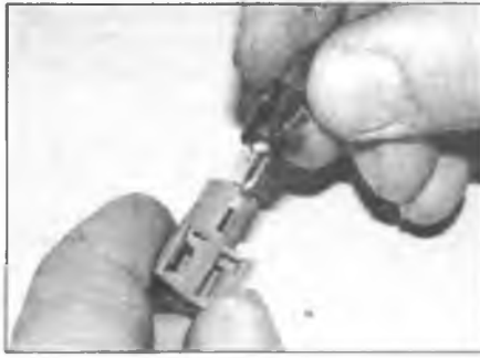
Рис. 6.19. Лампа фиксируется в патроне по плотной посадке и для замены ее можно просто вытянуть из патрона
