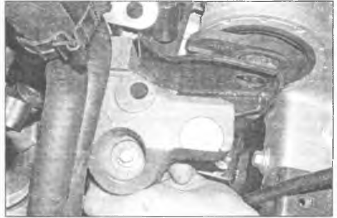
Рис. 8.65. Снимите грузик (при наличии), закрепленный сверху на коробке передач
