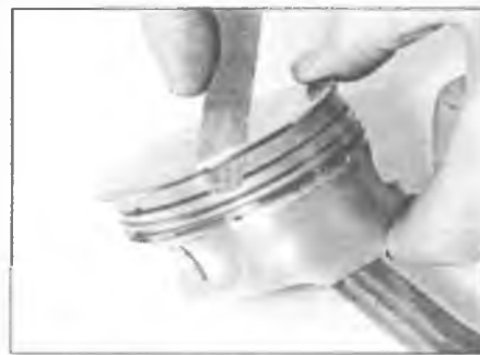
Рис. 15.2. При снятии поршневого кольца используйте щуп
