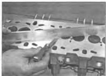
Рис. 10.6. С помощью линейки и щупа проверьте поверхность головки цилиндров на наличие деформации
