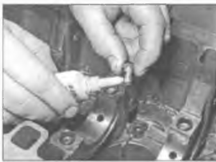
Рис. 14.11. Нанесите стопорящий компаунд на резьбу новых болтов крепления трубок смазки поршней
