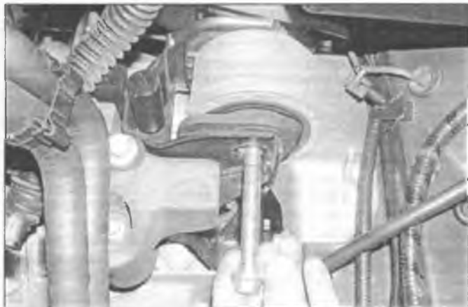
Рис. 14.9. Выверните анкерный болт левой опоры
