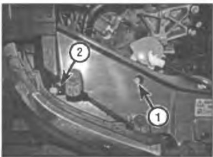
Рис. 8.2. Винты регулировки света фар 1 Вертикальная регулировка 2 Горизонтальная регулировка
