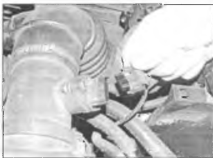
Рис. 27.2,б. ... и разъедините электрический разъем датчика массового расхода воздуха
