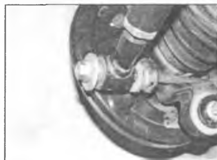
Рис. 10.5. Отверните гайку и удалите болт и шайбы крепления регулируемого рычага к опоре ступицы
