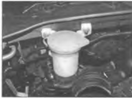
Рис. 18.3. Отверните две гайки крепления заливной горловины бачка к внутреннему брызговику
