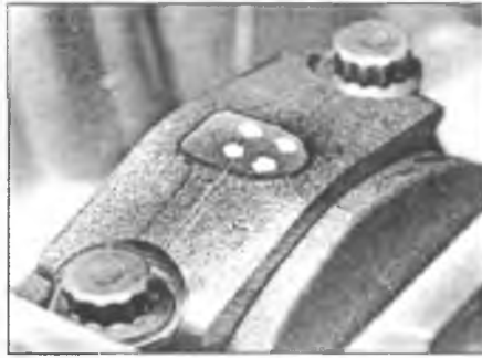
Рис. 12.5. Перед снятием каждой крышки подшипника нижней головки шатуна нанесите на нее маркировку в соответствии с номером цилиндра
