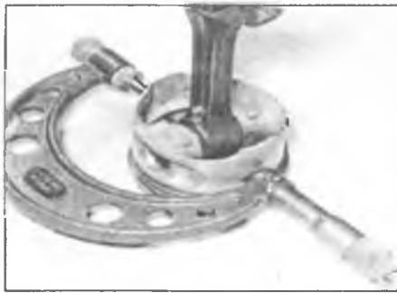
Рис. 15.10. Измерьте диаметр поршня под прямым углом к оси поршневого пальца
